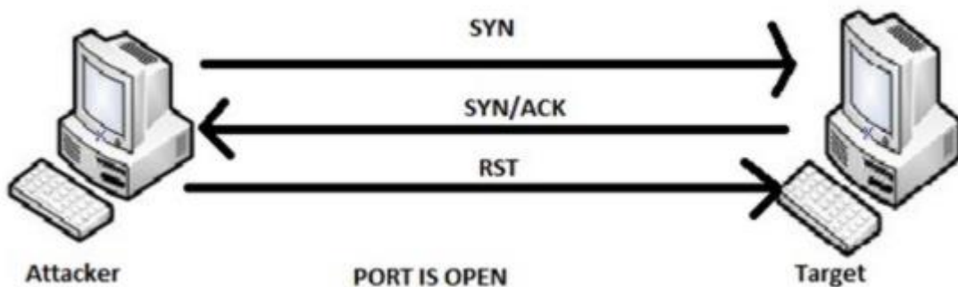
Sl. 2.9. TCP SYN Ping sken domaćina sa otvorenim odabranim portom[4]
