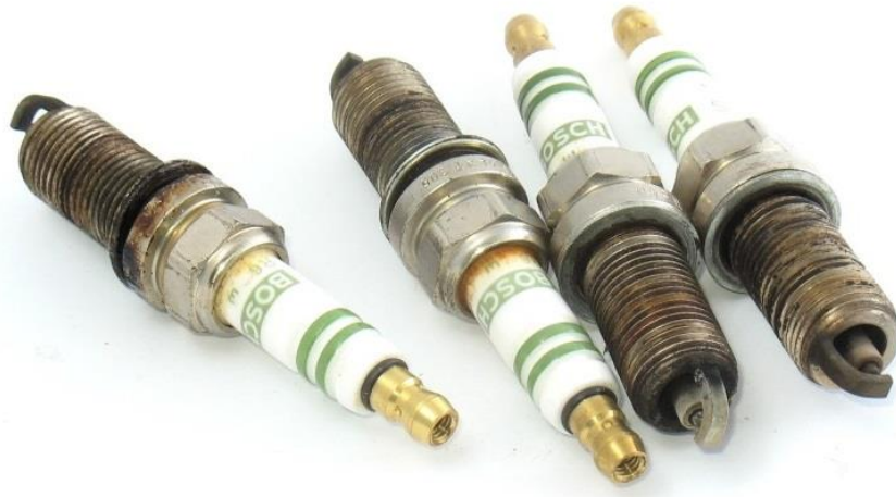
Slika 4.8. Središnja elektroda svjećice izolirana porculanom [8].
