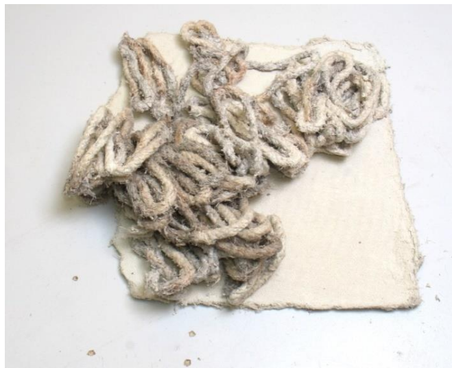
Slika 4.9. Komad azbestne ploče i starog azbestnog užeta [8].
