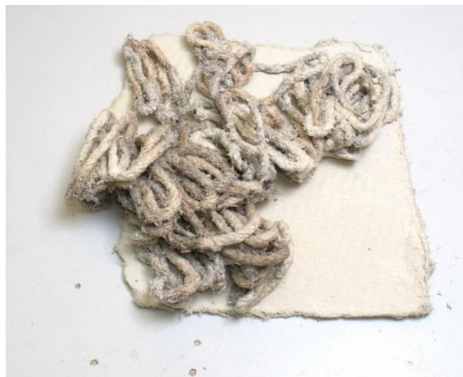
**Slika 4.9.** Komad azbestne ploče i starog azbestnog užeta [8].
