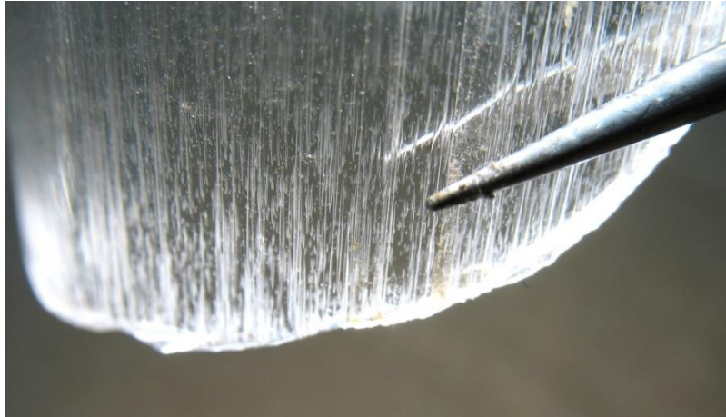
Slika 3.7. Komad tehničkog kvarcnog stakla. [8]
