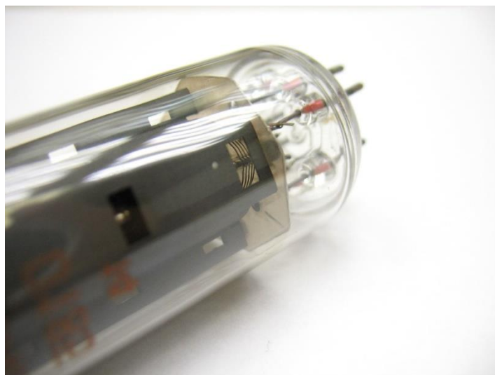
Slika 3.5. Osmerokutna pločica izrađena od tinjca [8].
