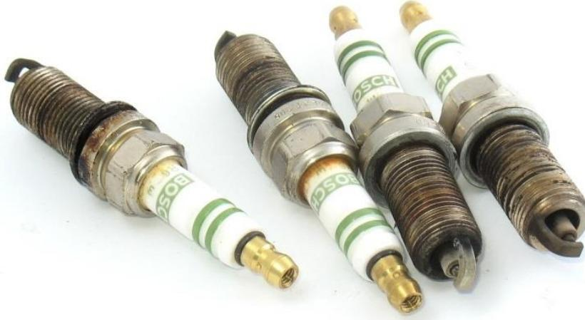
**Slika 4.8.** Središnja elektroda svjećice izolirana porculanom [8].
