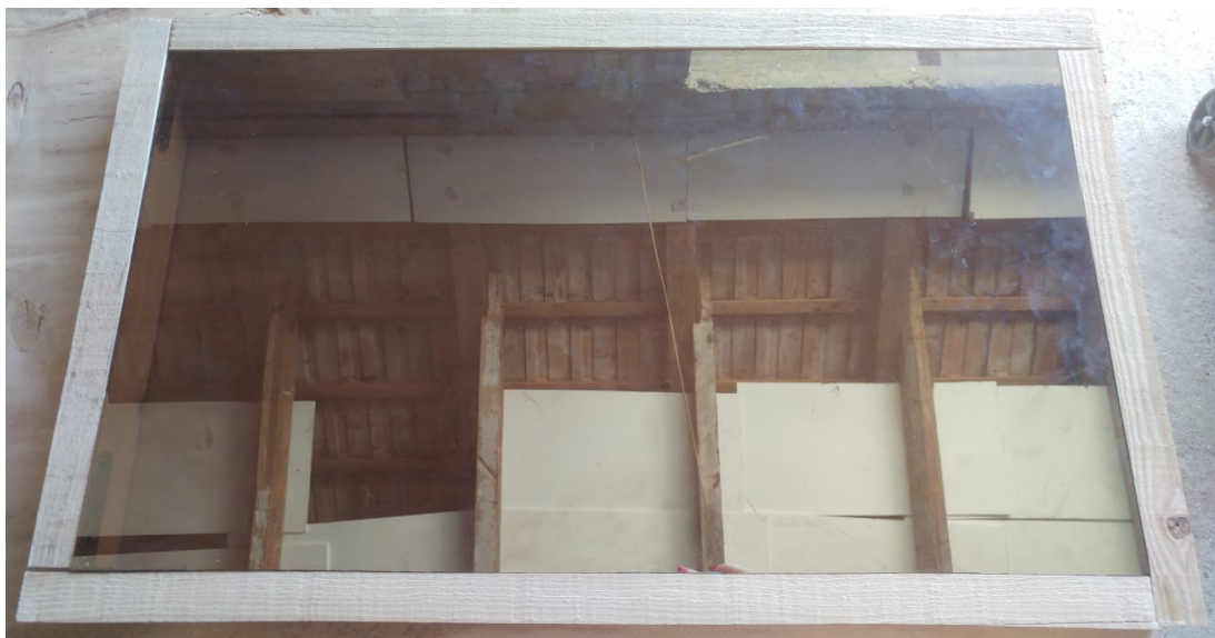
Slika 4.1. Prikaz prednjeg dijela okvira - akrilno dvosmjerno zrcalo
