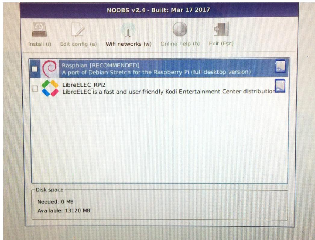
*Slika 3.2. Izbornik NOOBS bez instaliranog operativnog sustava [11, str. 31]*
