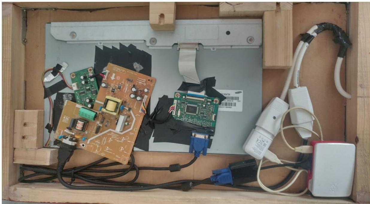
*Slika 4.12. Konačan izgled pametnog zrcala s električnim komponentama*
