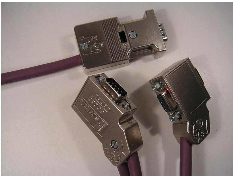
Slika 2.3. Primjer tipičnih konektora za povezivanje Profibus uređaja [3]
