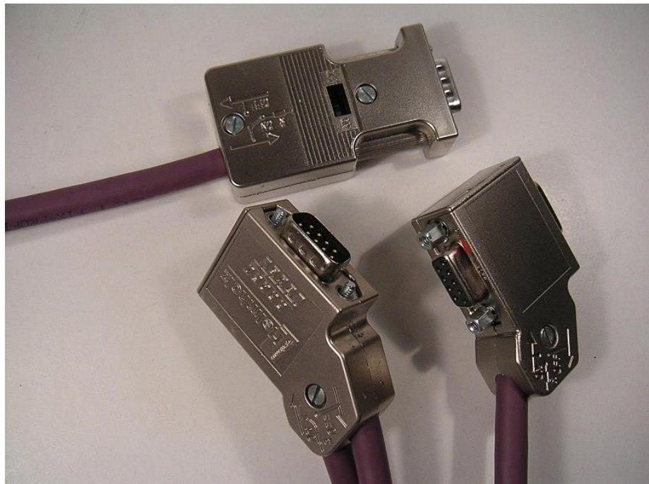
Slika 2.3. Primjer tipičnih konektora za povezivanje Profibus uređaja [3]
