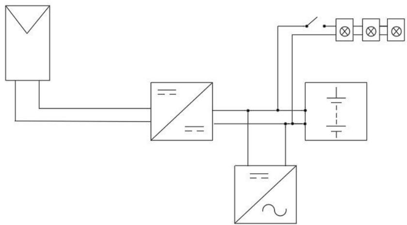
**Slika 3.4.** Shema napajanja solarnog sustava
