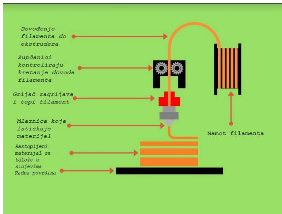
Slika 2.6. FDM (*fused deposition modeling*) tehnologija ispisa [8]
