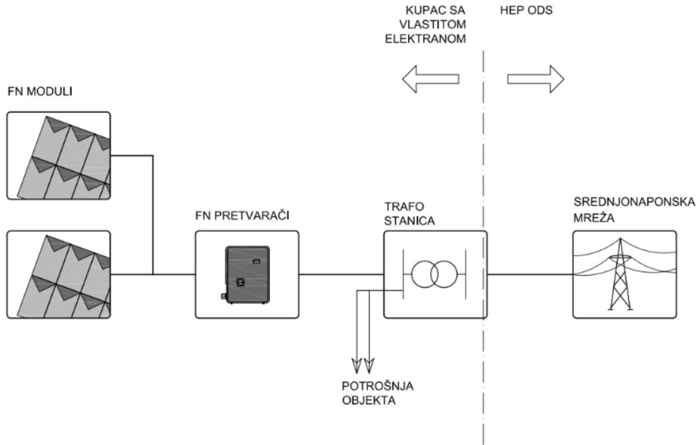
**Slika 2.5.** Shema sunčane elektrane priključene na elektroenergetsku mrežu [7]
