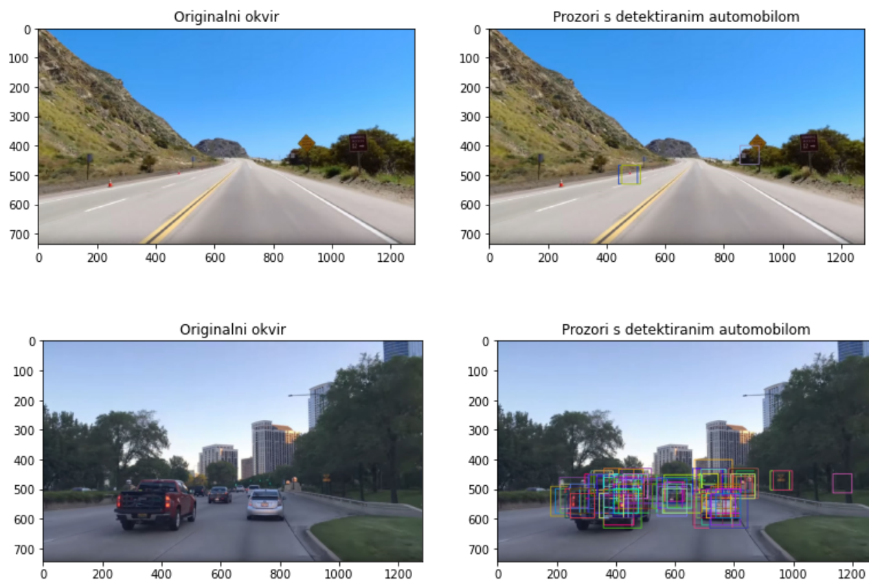
Slika 4.1 Lokalizirani prozori s detektiranim automobilom.
