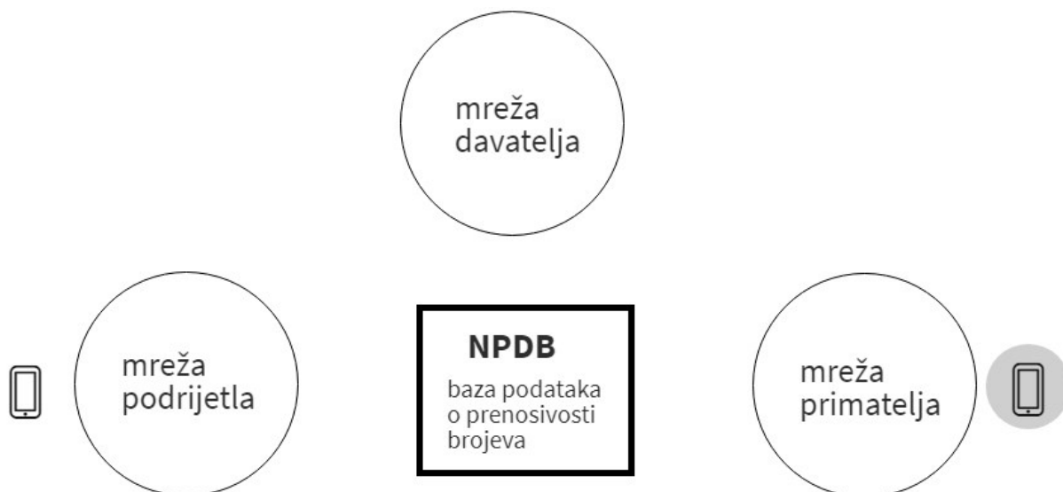
Slika 2.2. Shema mreža i baze podataka o prenosivosti brojeva
