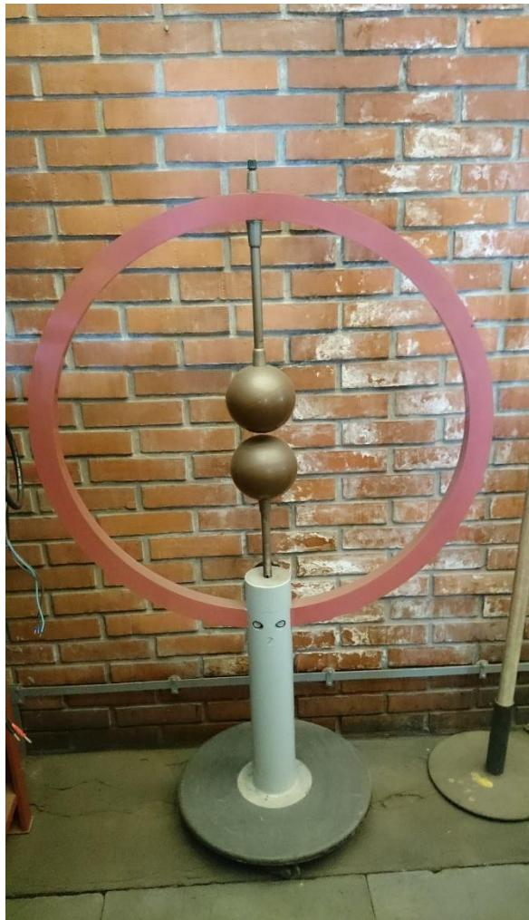
**Slika 2.5** Primjer kuglastog iskrišta
