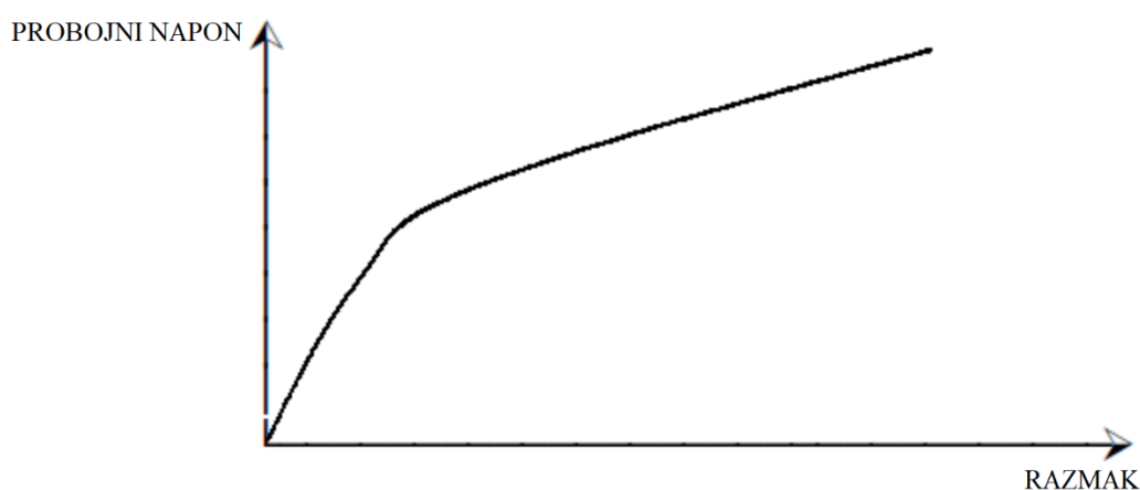
Slika 2.3 Karakteristika probojnog napona mjenog kuglastim iskrištem [2]
