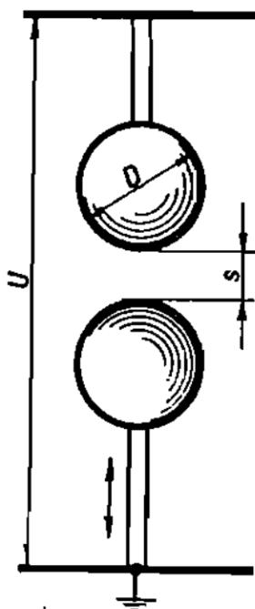
Slika 2.1 Kuglasta iskrišta [5]
