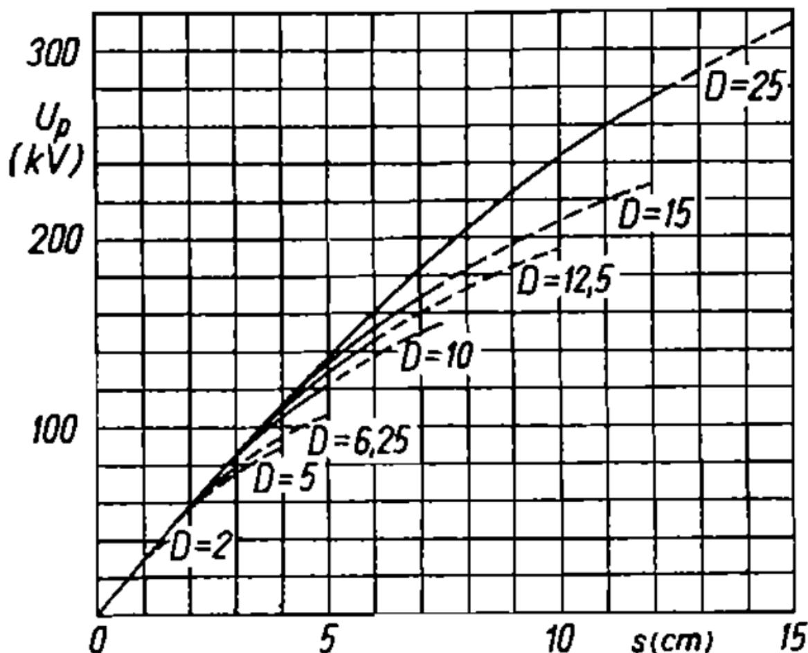
Slika 2.2 Tjemene vrijednosti probognih napona u kV za jednopolno uzemljena kuglasta iskrišta kod 20 °C i 101 325 Pa za izmjenični napon, negativni udarni napon i istosmjerni napon oba polariteta [5]
