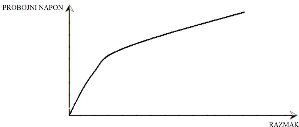
**Slika 2.3** Karakteristika probajnog napona mjerenu kuglastim iskrištem [2]
