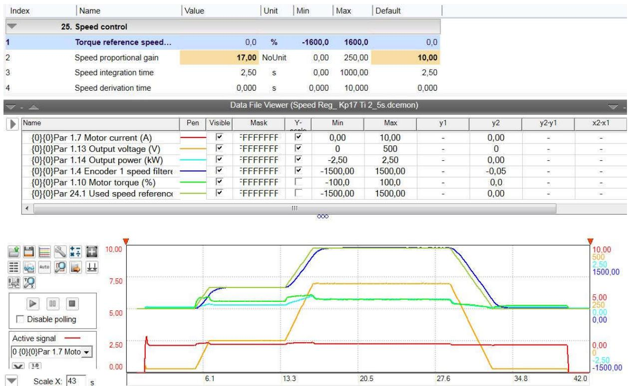
Sl. 4.34. Rampa reference brzine vrtnje sa proporcionalnim pojačanjem  $K_p=17$  i integracijskom komponentom  $T_i=2.5$  s
