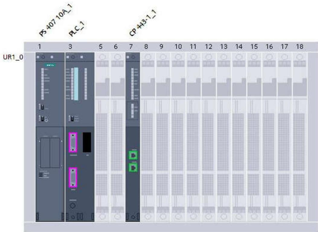
Sl. 5.1. Sklopoška konfiguracija PLC-A Siemens S400
