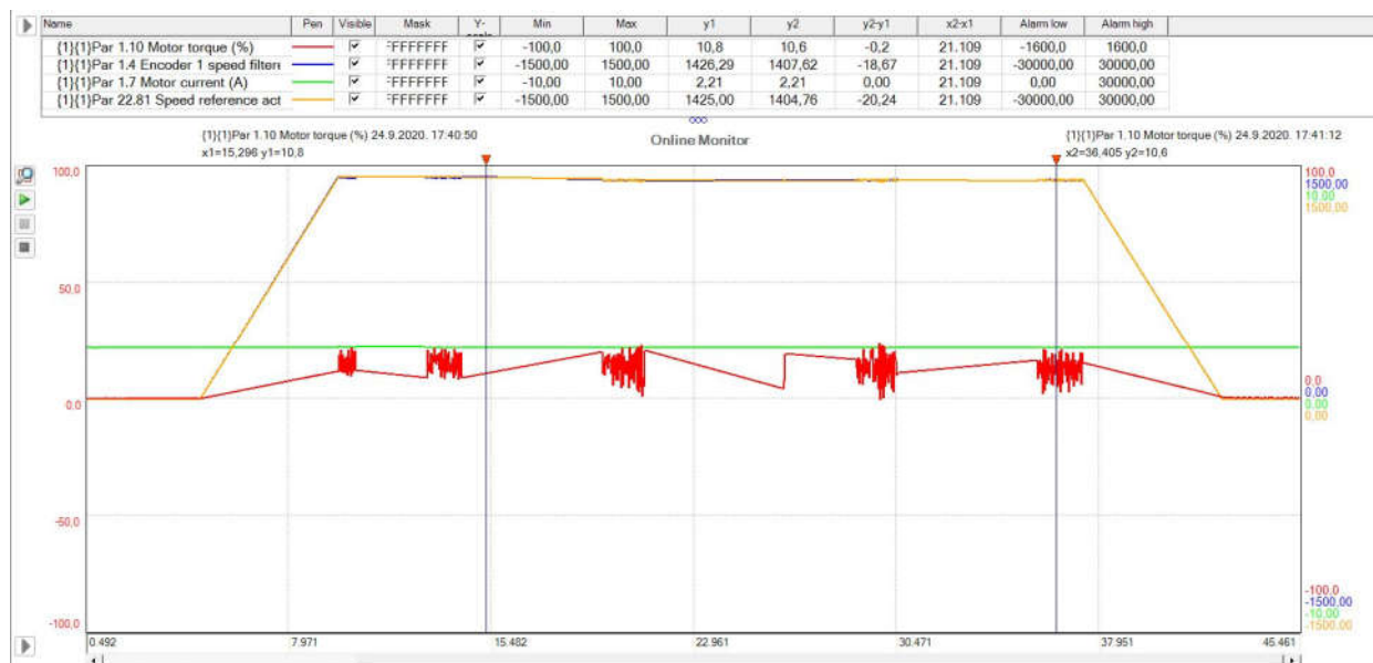
Sl. 6.8. Postupni zalet asinkronog motora na nazivnu brzinu vrtnje
