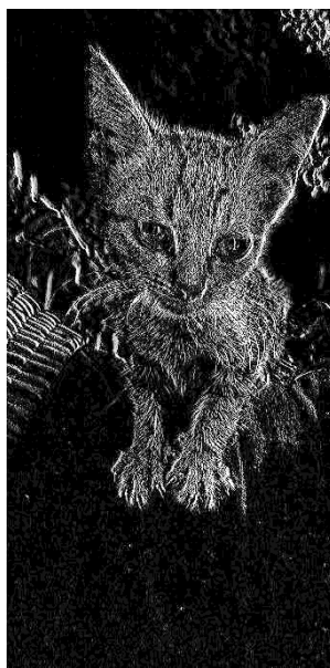
Slika 4.3. Komponenta gradijenata u smjeru x osi (“ksize=1”)
