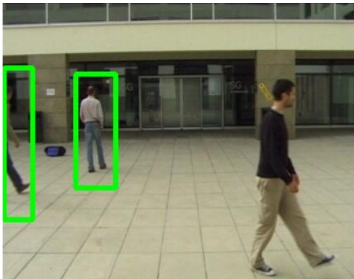
Slika 5.2. Netočna detekcija pješaka Izvor: [5]
