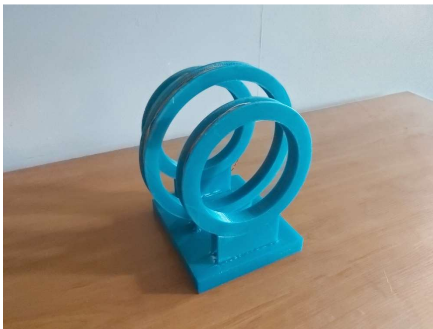
Slika 4.20 – Fizička maketa Maxwellovog sustava svitaka
