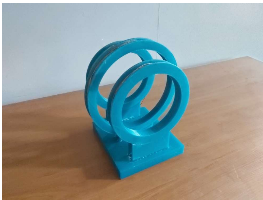
Slika 4.20 – Fizička maketa Maxwellovog sustava svitaka
