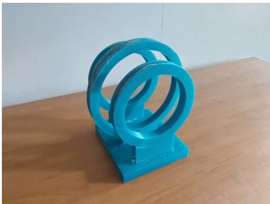
Slika 4.20 – Fizička maketa Maxwellovog sustava svitaka
