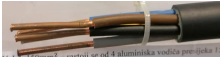
Slika 7.8: Kabel – EYY-J 5 \times 10 \text{mm}^2
