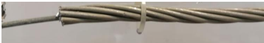
Slika 7.21: Vodić– AlFe- 25/4 \text{ mm}^2
