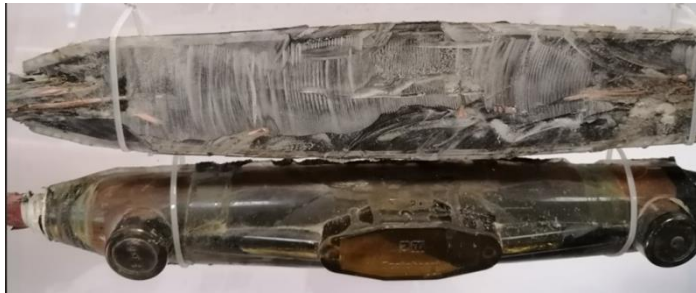
Slika 7.10: Spojka kabela Scotchcast 3M
