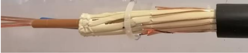
Slika 7.4: Kabel – NYCY 2 \times 4 \text{mm}^2
