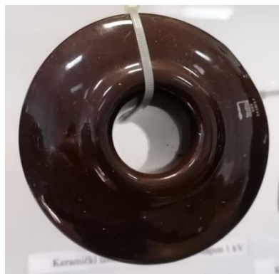
Slika 7.12: Keramički izolator – N-80
