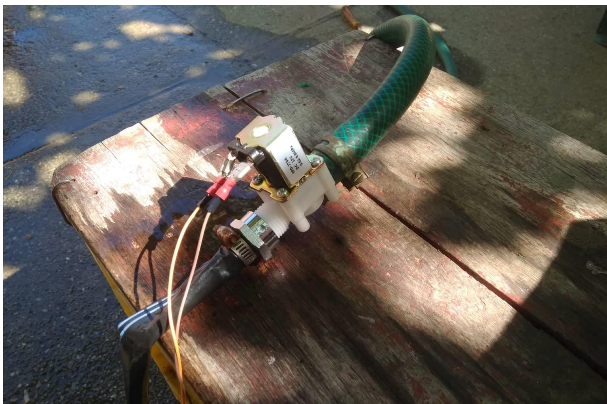
Slika 4.8: Magnetni ventil spojen na vrtno crijevo i crijevo za kap po kap navodnjavanje.
