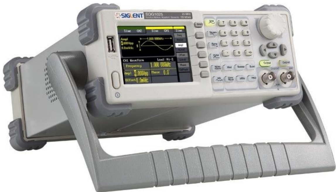
Slika 3.2.1. Generator funkcija „SIGLENT SDG1025“
