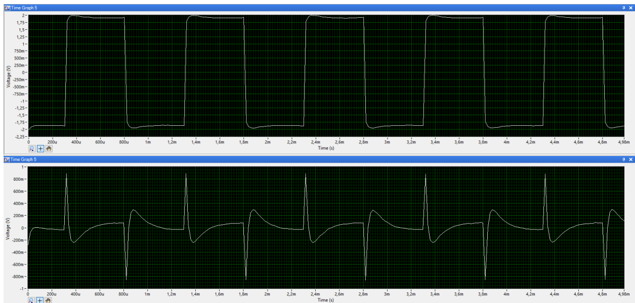
Slika 3.3.11. Gornji graf- valni oblik napona ulaza U , donji graf-valni oblik napona na induktivitetu U_L
