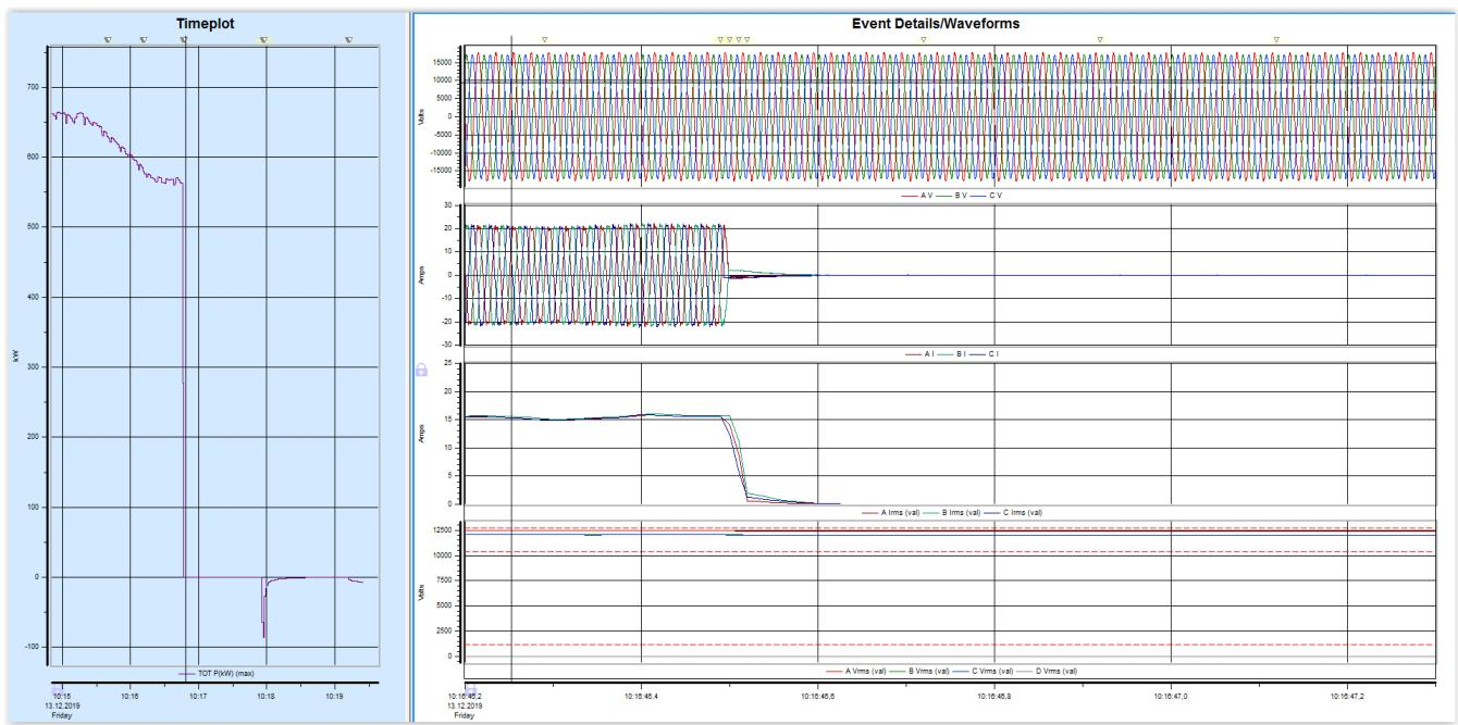
**Slika 6.6.** Grafički prikaz zabilježenih iznosa snage, struje i napona u trenutku isključenja prekidača za odvajanje s naznačenim vremenom u “ms” – mjerjenje na OMM u RSTS 20/0,4 kV
