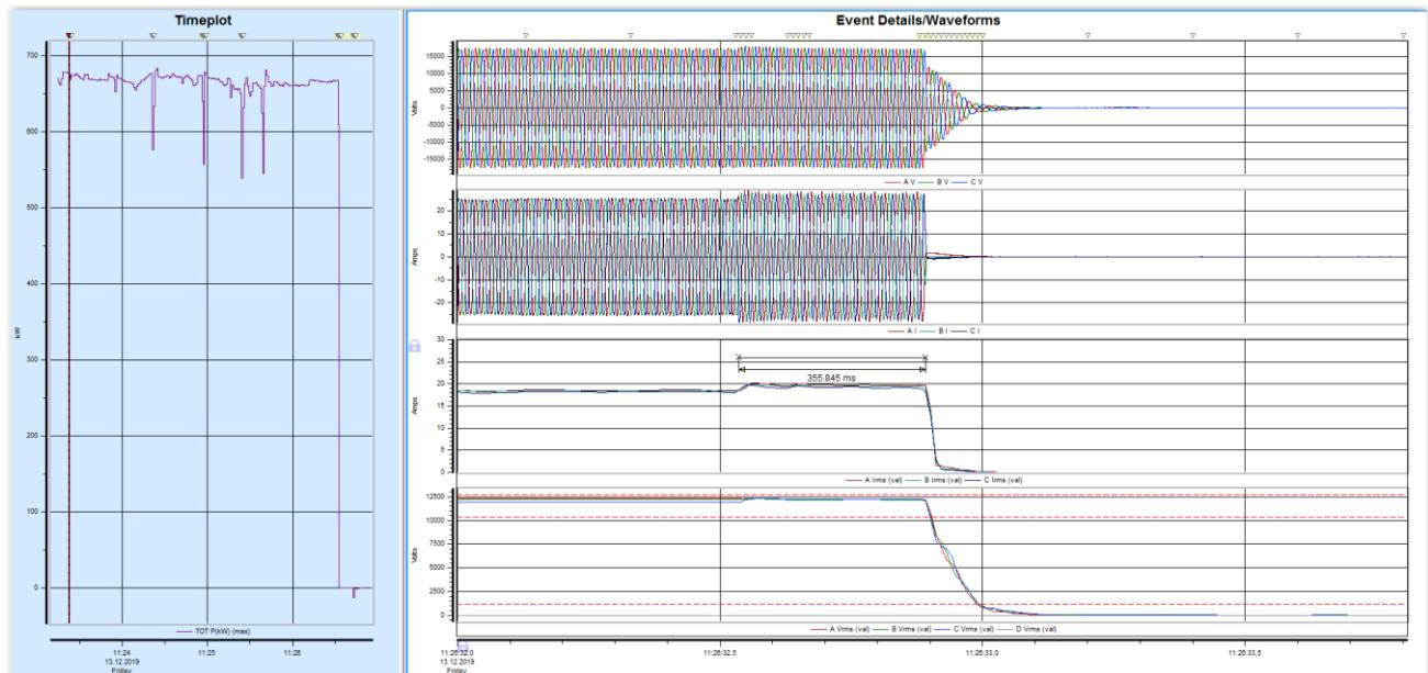
**Slika 6.10.** Grafički prikaz zabilježenih iznosa snage, struje i napona u trenutku isključenja prekidača za odvajanje s naznačenim vremenom u "ms" – mjerjenje na OMM u RSTS 20/0,4 kV
