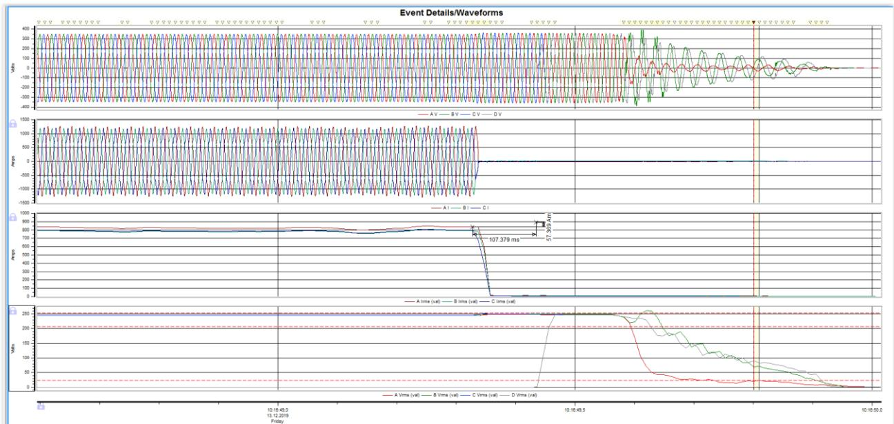
**Slika 6.8.** Grafički prikaz prepoznavanja izoliranog pogona i isključenja proizvodnje s mreže s naznačenim vremenom u “ms” djelovanjem zaštite od otočnog pogona – mjerjenje na NN glavnom prekidaču [3]
