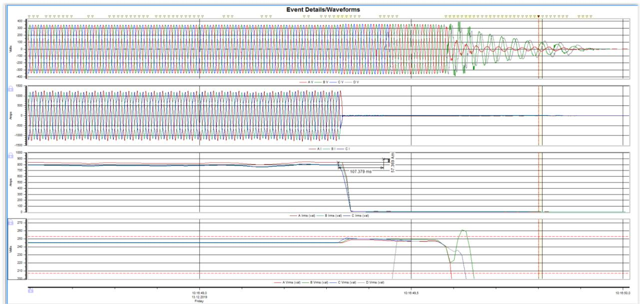
**Slika 6.7.** Grafički prikaz prepoznavanja izoliranog pogona i isključenja proizvodnje s mreže s naznačenim vremenom u ‘ms’ djelovanjem zaštite od otočnog pogona – mjerjenje na NN glavnom prekidaču [3]
