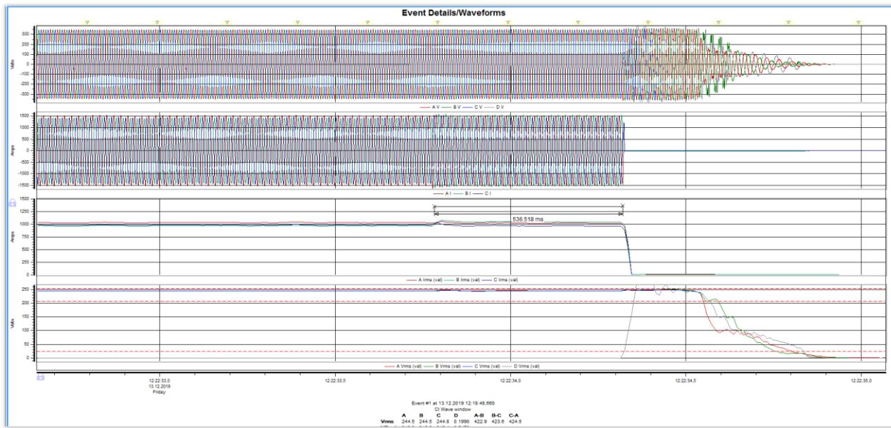
**Slika 6.12.** Grafički prikaz prepoznavanja otočnog pogona i isključenja elektrane s mreže s naznačenim vremenom u "ms", djelovanjem zaštite od otočnog pogona – mjerene na NN glavnom prekidaču [3]
