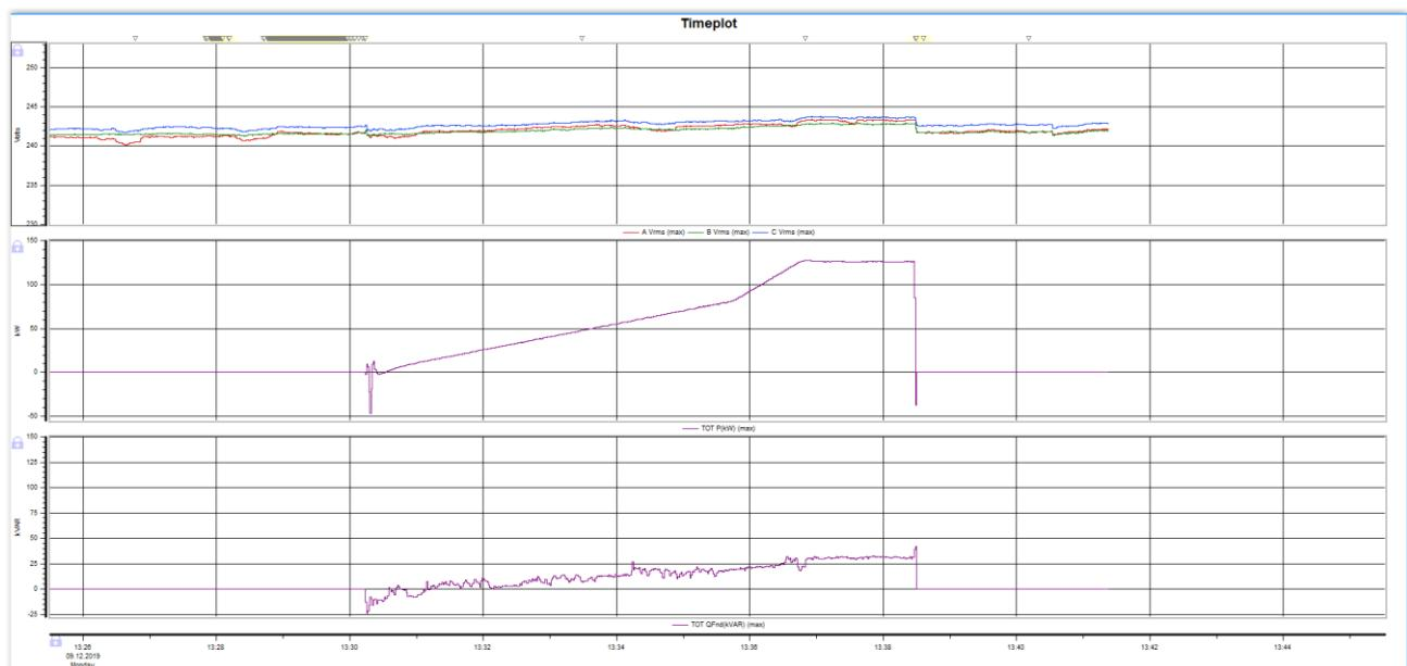
**Slika 6.2.** Grafički prikaz sinkronizacije za G2 (tipski generator) – mjereno na generatorskom prekidaču sa sklopnikom na G2 [3]
