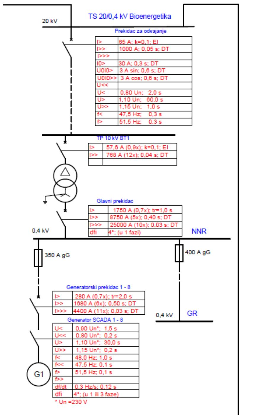
Slika 8.2. Konačna podešenja reljejne zaštite u TS 20/0,4 kV Bioenergetika [3]
