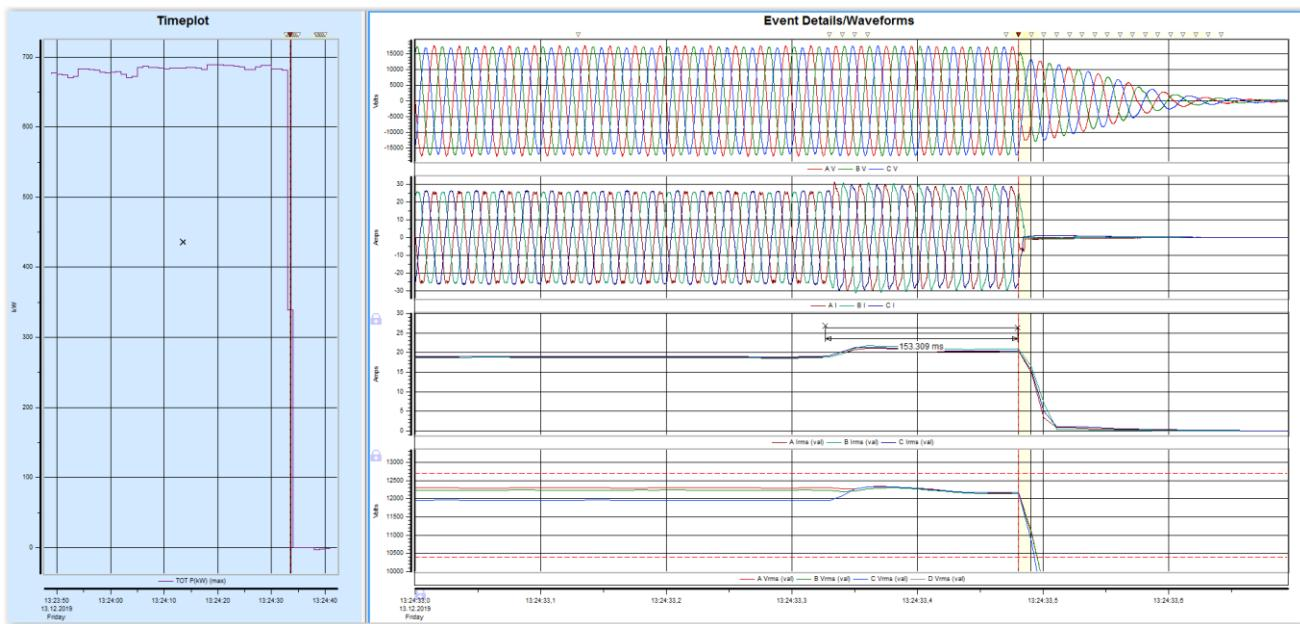
**Slika 6.13.** Grafički prikaz prepoznavanja otočnog pogona i isključenja elektrane s mreže s naznačenim vremenom u “ms”, djelovanjem zaštite od otočnog pogona - mjerjenje na OMM u RSTS 20/0,4 kV Bioenergetika [3]
