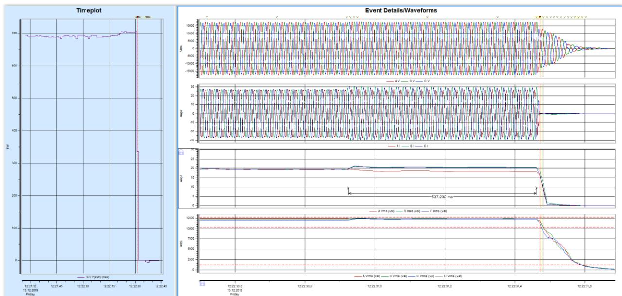
Slika 6.11. Grafički prikaz prepoznavanja otočnog pogona i isključenja elektrane s mreže s naznačenim vremenom u "ms", djelovanjem zaštite od otočnog pogona - mjerjenje na OMM u RSTS 20/0,4kV Bioenergetika [3]
