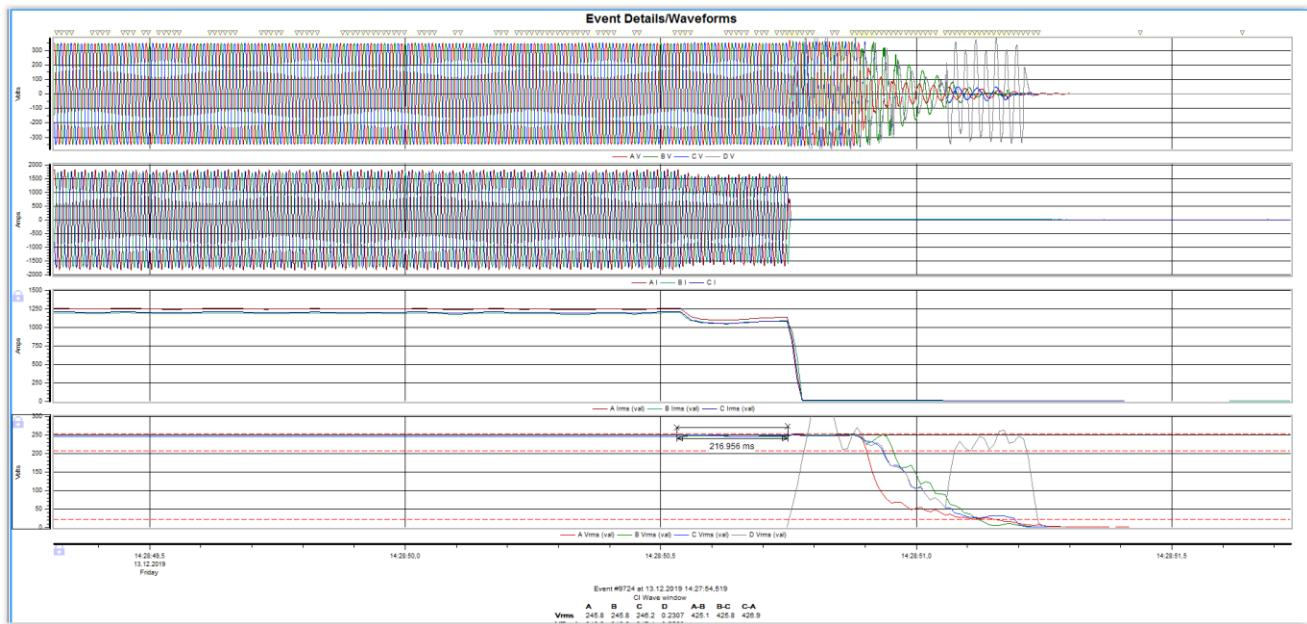
**Slika 6.17.** Grafički prikaz prolaska (odziva) elektrane kroz ciklus brzog APU-a, prepoznavanja otočnog pogona i isključenja elektrane s mreže s naznačenim vremenom u “ms“ - mjerjenje na NN glavnom prekidaču [3]
