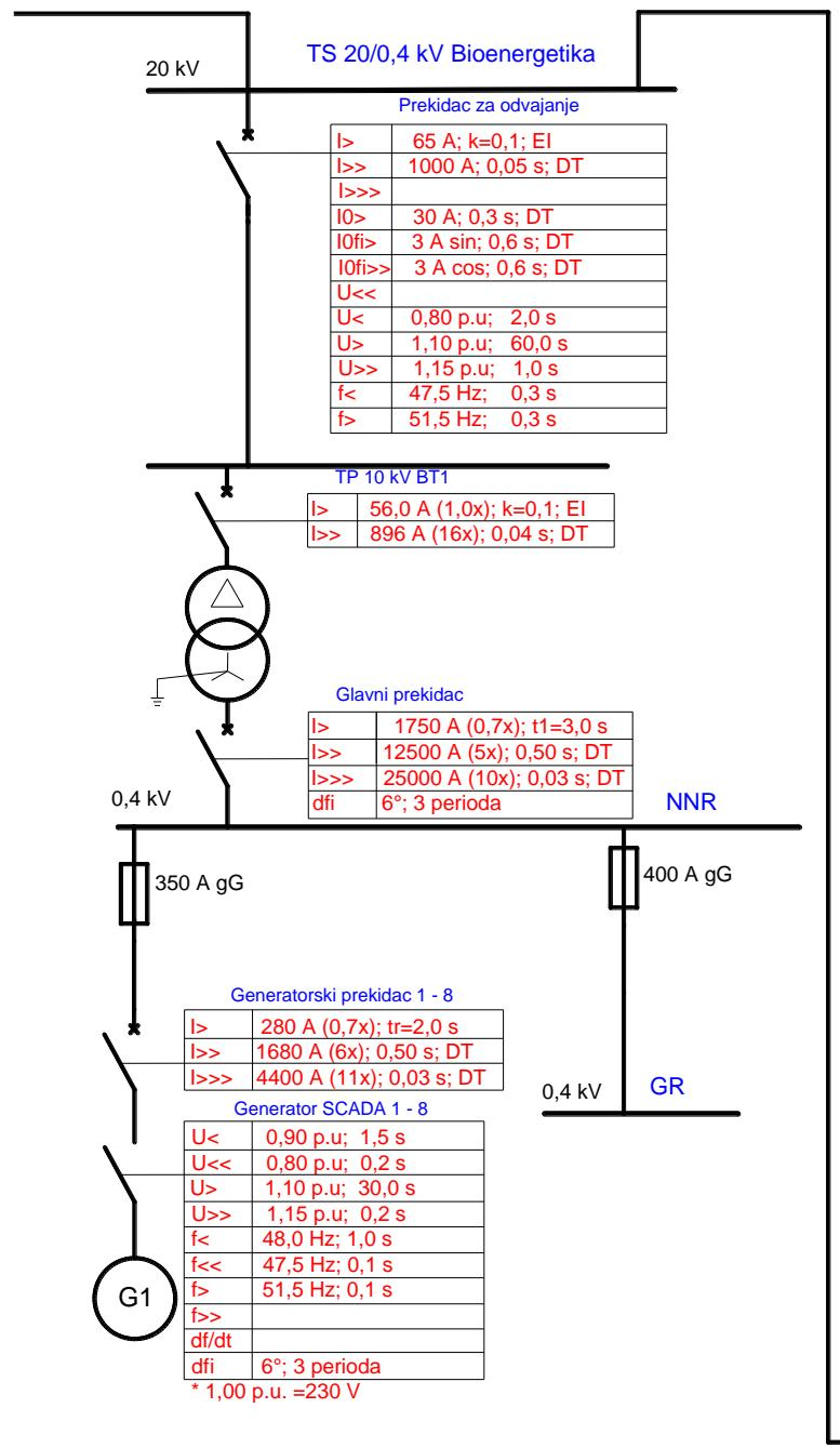
**Slika 4.4.** Podešenje reljene zaštite u TS 20/0,4 kV Bioenergetika [3]
