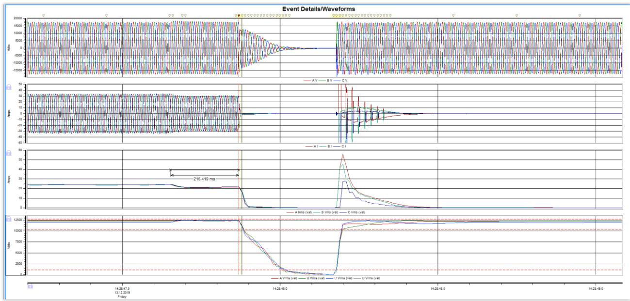
**Slika 6.15.** Grafički prikaz prolaska (odziva) elektrane kroz ciklus brzog APU-a, prepoznavanja otočnog pogona i isključenja elektrane s mreže s naznačenim vremenom u “ms“ - na OMM u RSTS 20/0,4 kV Bioenergetika [3]
