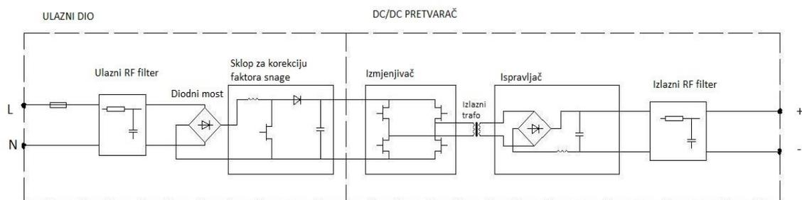
Slika 4.2. Blok shema ispravljača [1]
