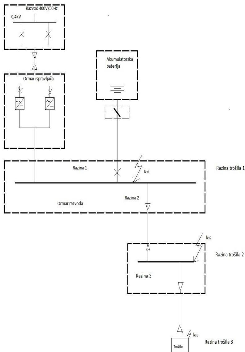
Slika 2.1. Shema istosmjernog razvoda u tri razine s označenim glavnim dijelovima [2]
