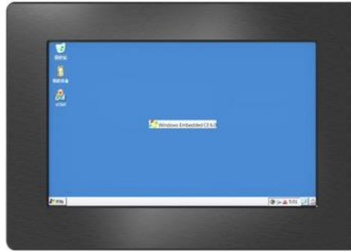
Slika 2.6. Industrijski HMI osjetljiv na dodir [6]
