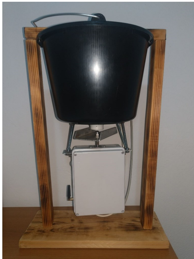
Slika 4.4. Realiziran model automatske hranilice za divljač
