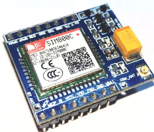
Slika 3.6. GSM modul SIM800C
