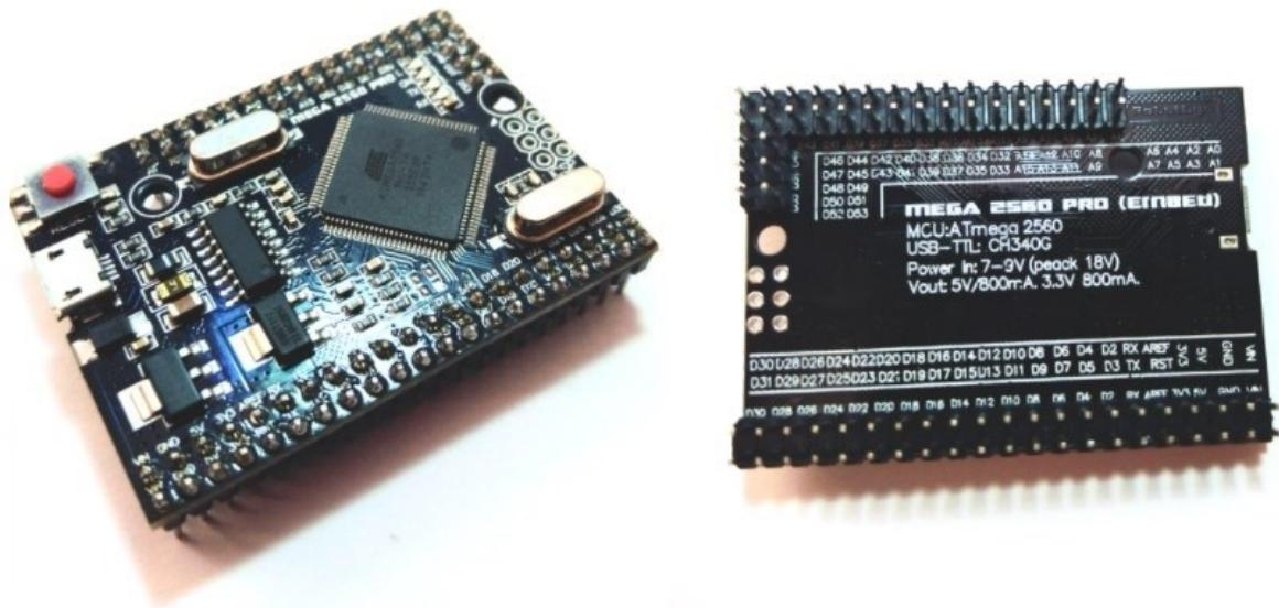
*Slika 3.4. Mikroupravljačka pločica kompatibilna s Arduino 2560 Mega*
