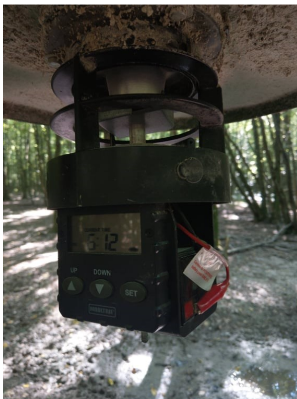
Slika 2.3. Automatska hranilica marke „Moultrie Feeders“ bez zaštitnog poklopca
