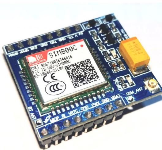
*Slika 3.6. GSM modul SIM800C*
