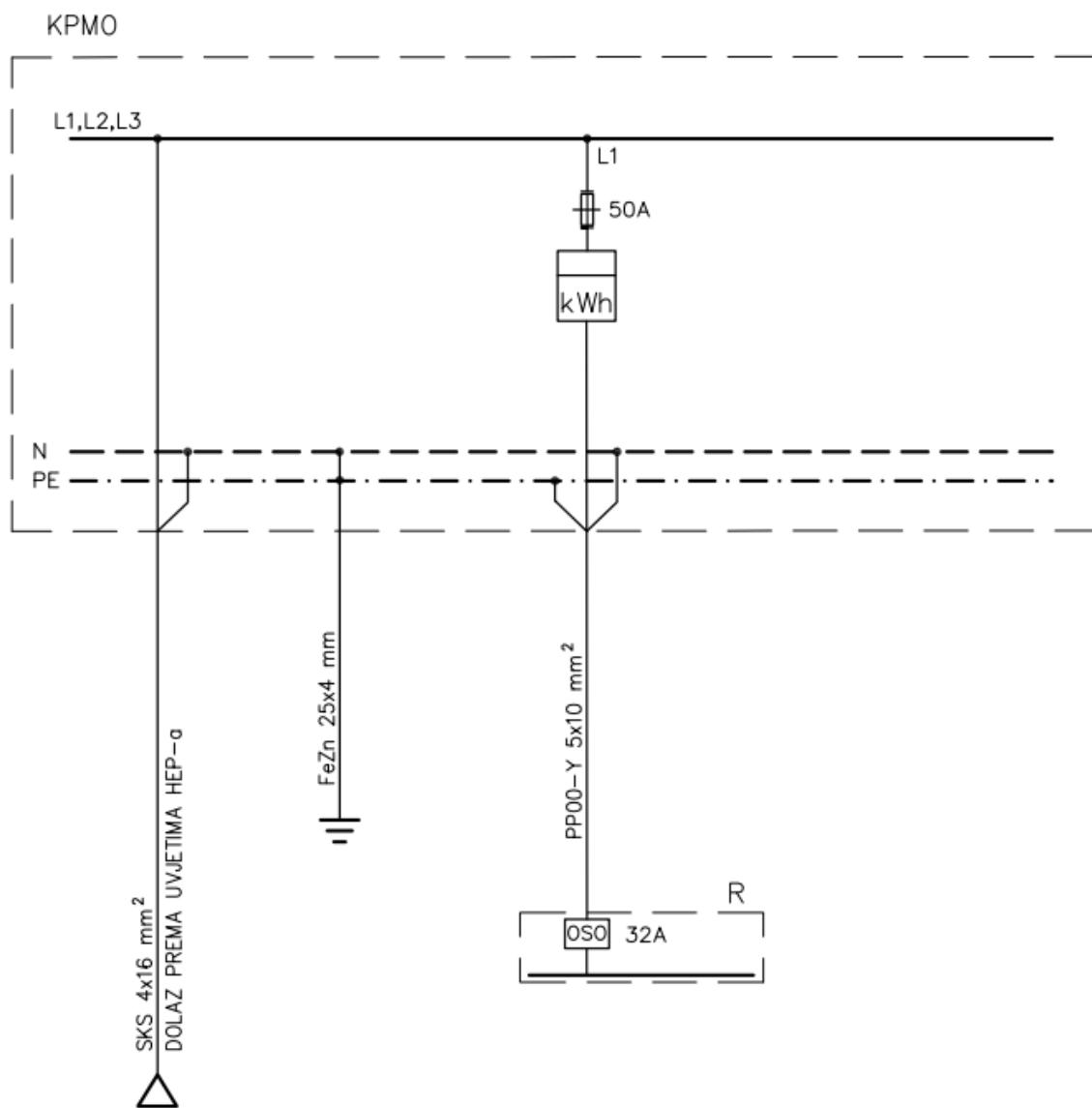
Slika 4. Shema NN elektroenergetskog raspleta građevine [1]
