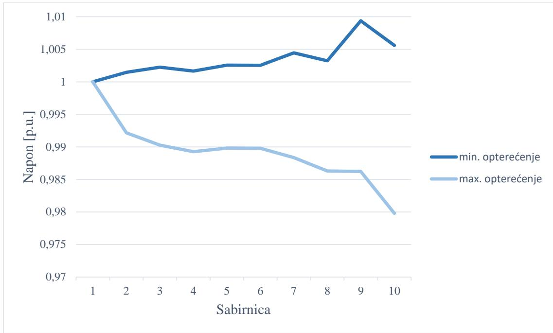
**Slika 5.20.** Jedinične vrijednosti napona sabirnica 1 – 11 za minimalno opterećenje (u 4 sata) i maksimalno opterećenje (u 21 sat) za slučaj 3 kada na mrežu nije priključena elektrana, te kada je napon SVC-a postavljen na 1,00938
