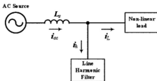
Slika 1 5.1. Pasivni filter [9]
