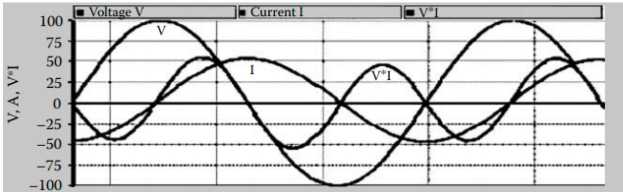
Slika 2.2. Odnos napona, struje i snage u strujnom krugu sa zavojnicom [3]
