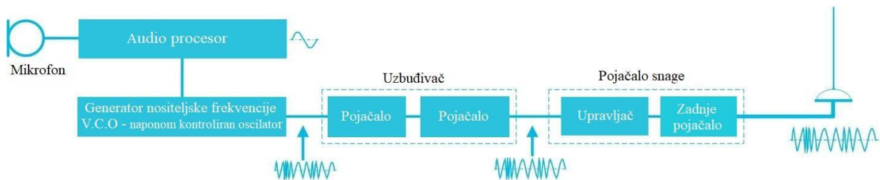
Slika 8. Princip rada FM predajnika
