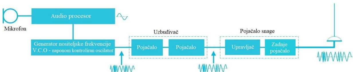
Slika 8. Princip rada FM predajnika
