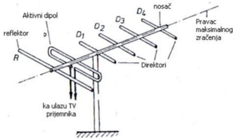
Slika 10. Yagi antena
