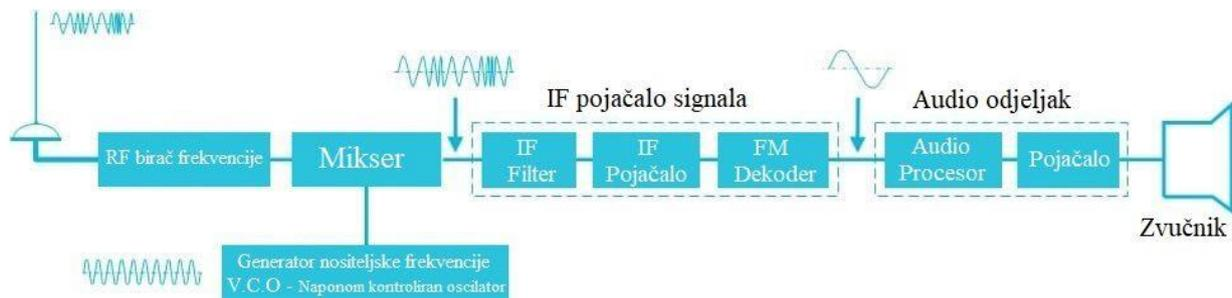
Slika 9. Princip rada FM prijmnika
