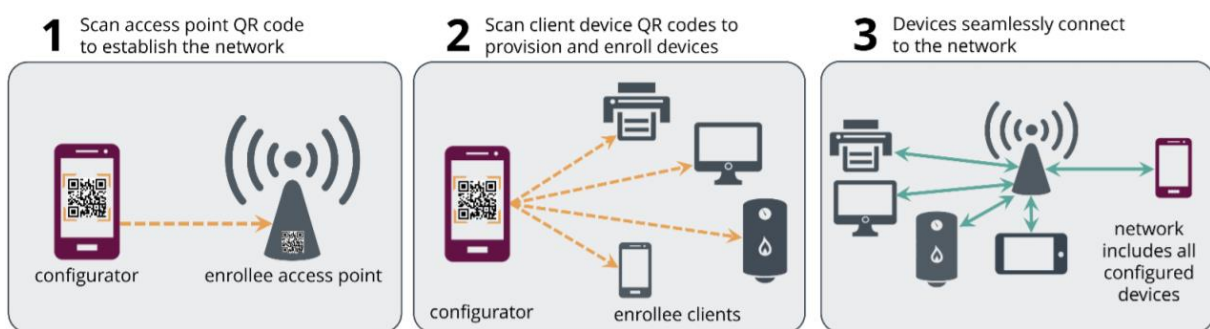
Slika 3.3: Wi-Fi Easy Connect princip rada. [16]
