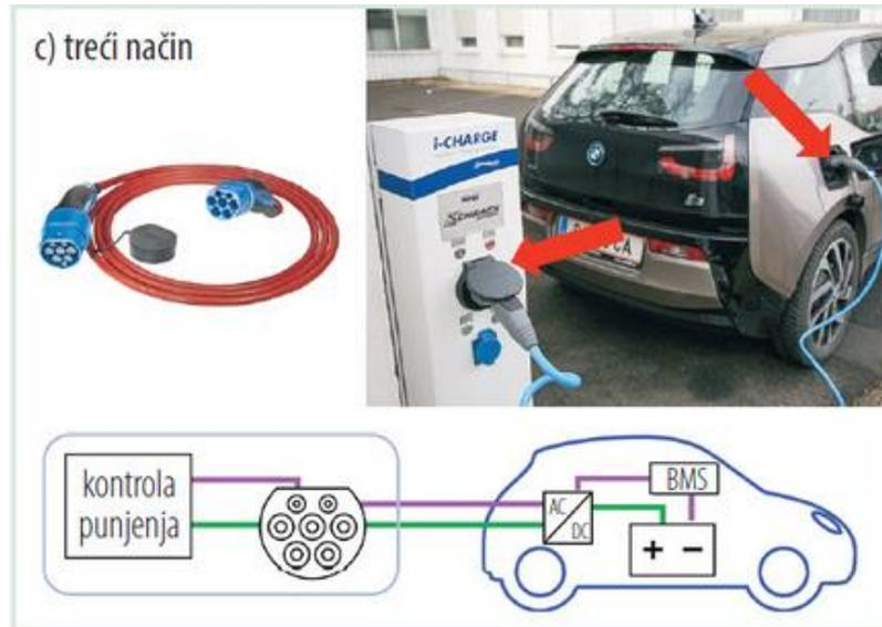
**Slika 4.4.** Treći način punjenja električnih vozila [19]
