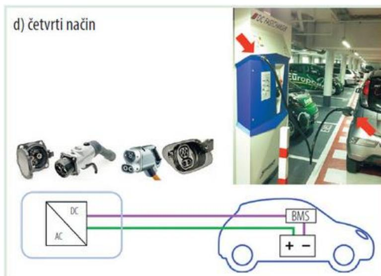
**Slika 4.5.** Četvrti način punjenja električnih vozila [19]
