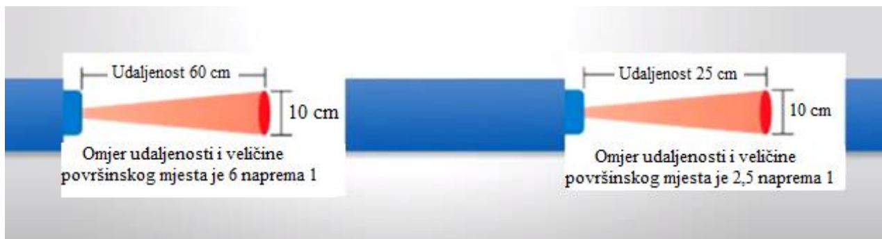
Slika 4.5. – Omjer udaljenosti između mjernog instrumenta i mjereno objekta, [25].
