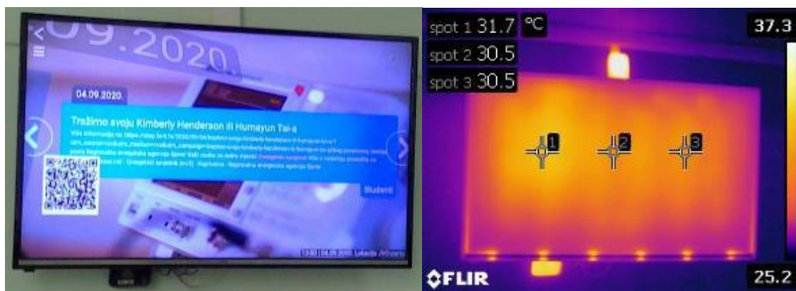
Slika 4.9. – Prikaz LCD LED televizora u vidljivom (lijevo) i infracrvenom (desno) spektru – rubno pozadinsko osvjetljenje.
