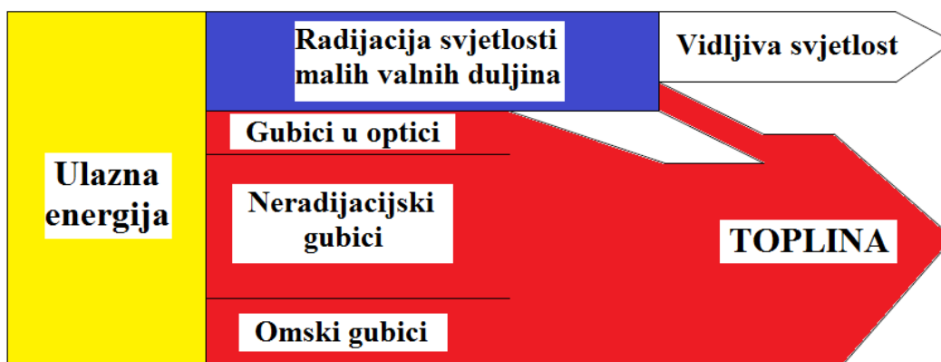
Slika 4.8. – Sankey dijagram energetske učinkovitosti bijele LED diode, [27].
