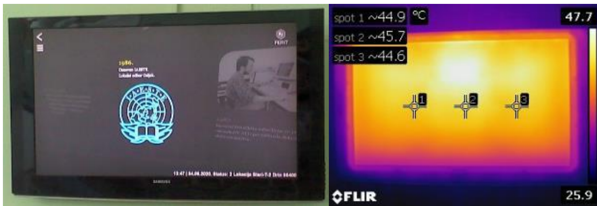
Slika 4.11. – Prikaz LCD LED televizora u vidljivom (lijevo) i infracrvenom (desno) spektru – direktno pozadinsko osvjetljenje.
