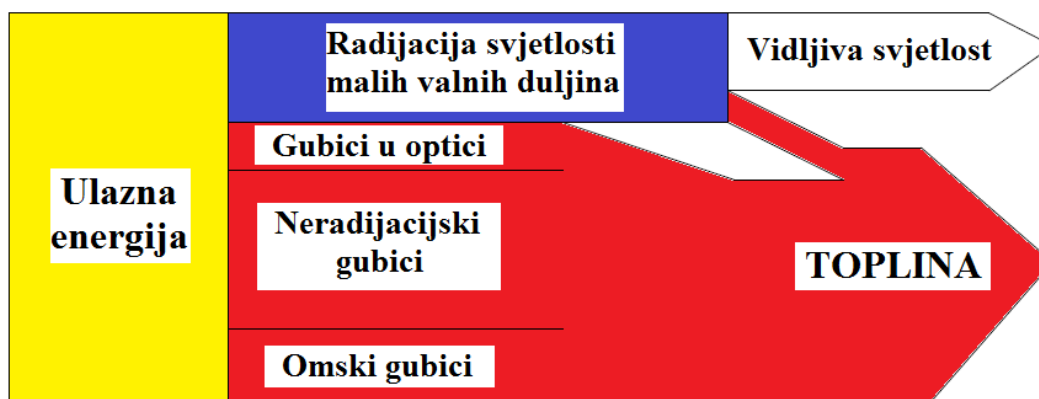
Slika 4.8. – Sankey dijagram energetske učinkovitosti bijele LED diode, [27].
