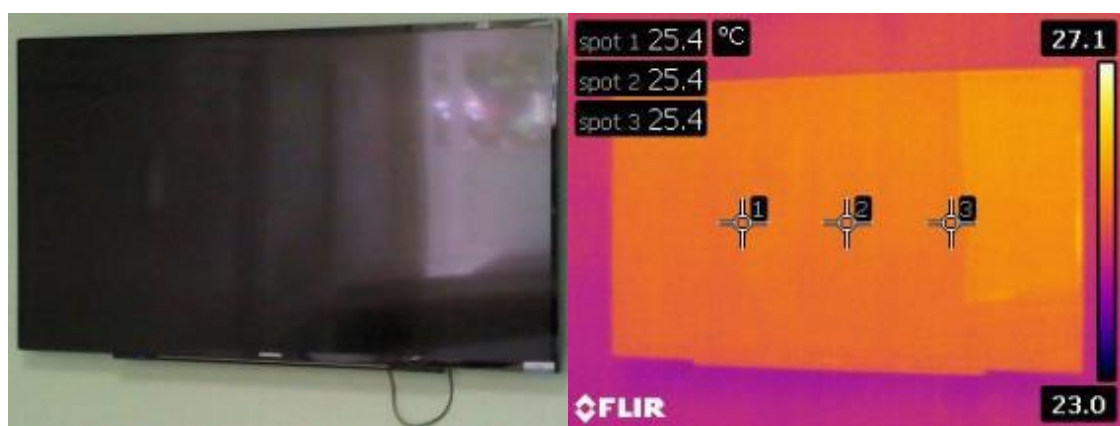
Slika 4.10. – Prikaz isključenog LCD LED televizora u vidljivom (lijevo) i infracrvenom (desno) spektru.
