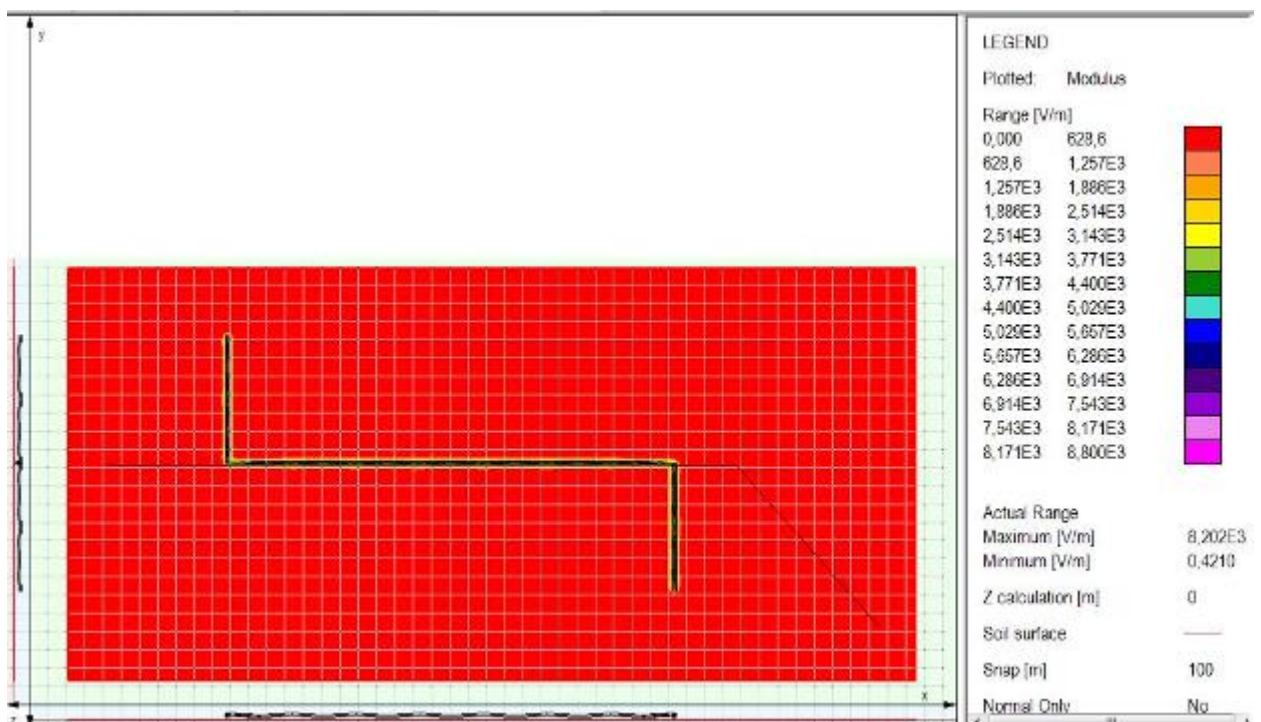
Slika 5.21. Jakost električnog polja na površini tla
