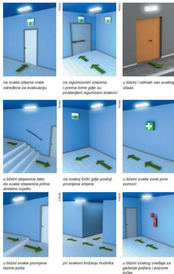
Slika 3.1. Pozicioniranje sigurnosne rasvjete [8]
