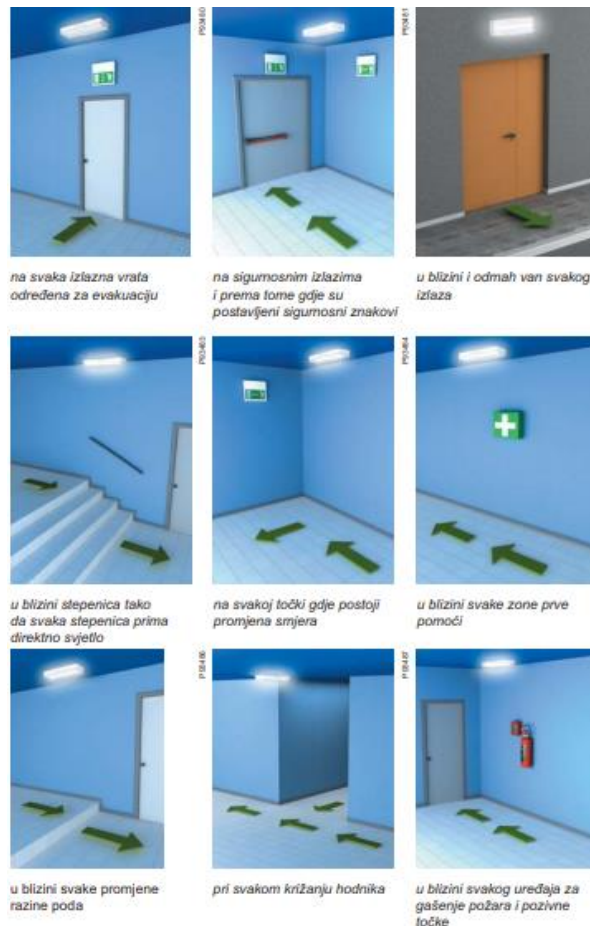
Slika 3.1. Pozicioniranje sigurnosne rasvjete [8]
