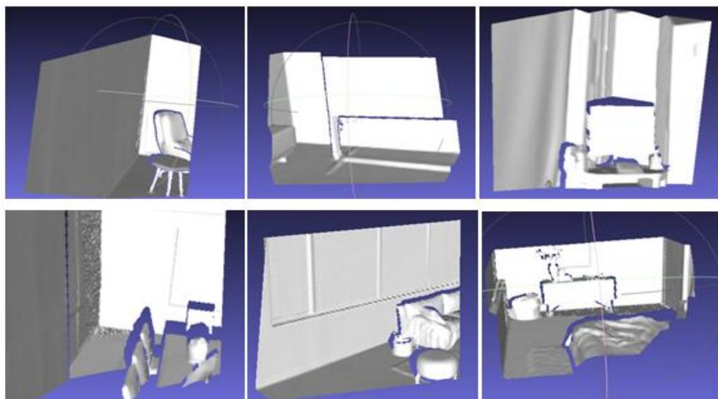
Slika 5.3 Dijelovi prostorije dobiveni algoritmom bez mjernog šuma.
