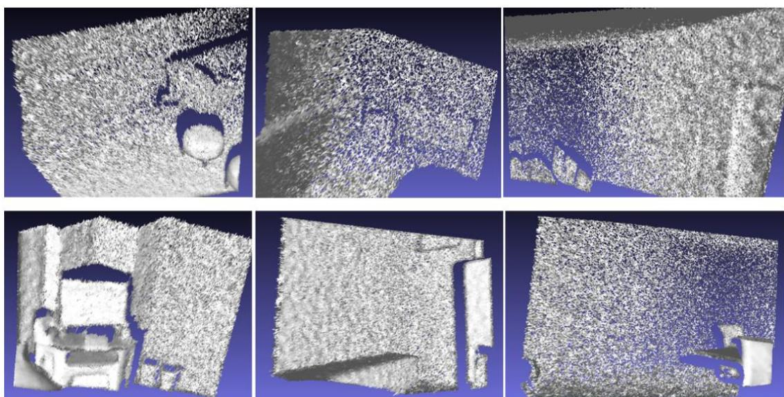
Slika 5.9 Dijelovi prostorije dobiveni algoritmom s razinom mjernog šuma od 0.005.
