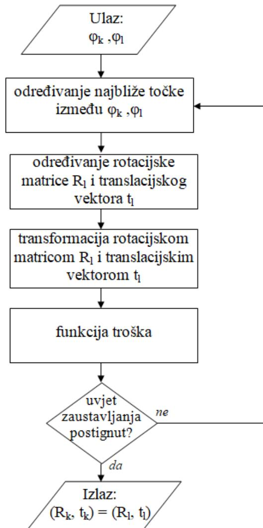
Slika 3.2 Dijagram toka ICP algoritma.
