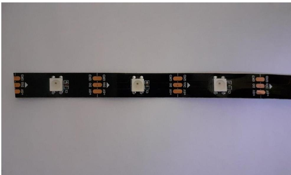
Slika 3.3 Izgled LE niza dioda 5050-30LED/M
