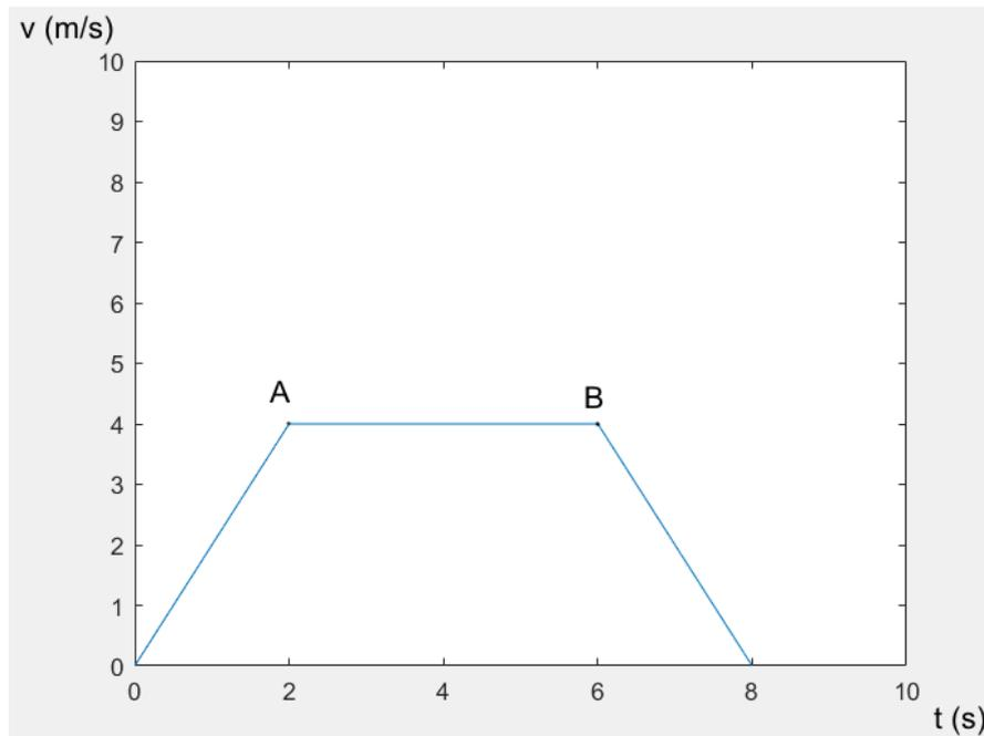
Slika 4.1 Promjena brzine dizala u ovisnosti o vremenu
