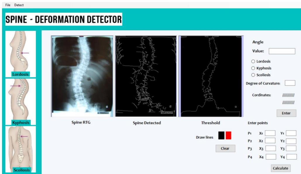
Slika 4.6 Detekcija Canny i Threshold metodom
