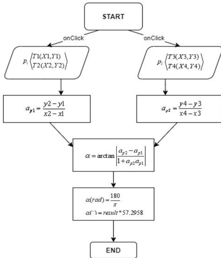
**Slika 4.11 Dijagran toka - Izračun kuta zakrivljenosti**
