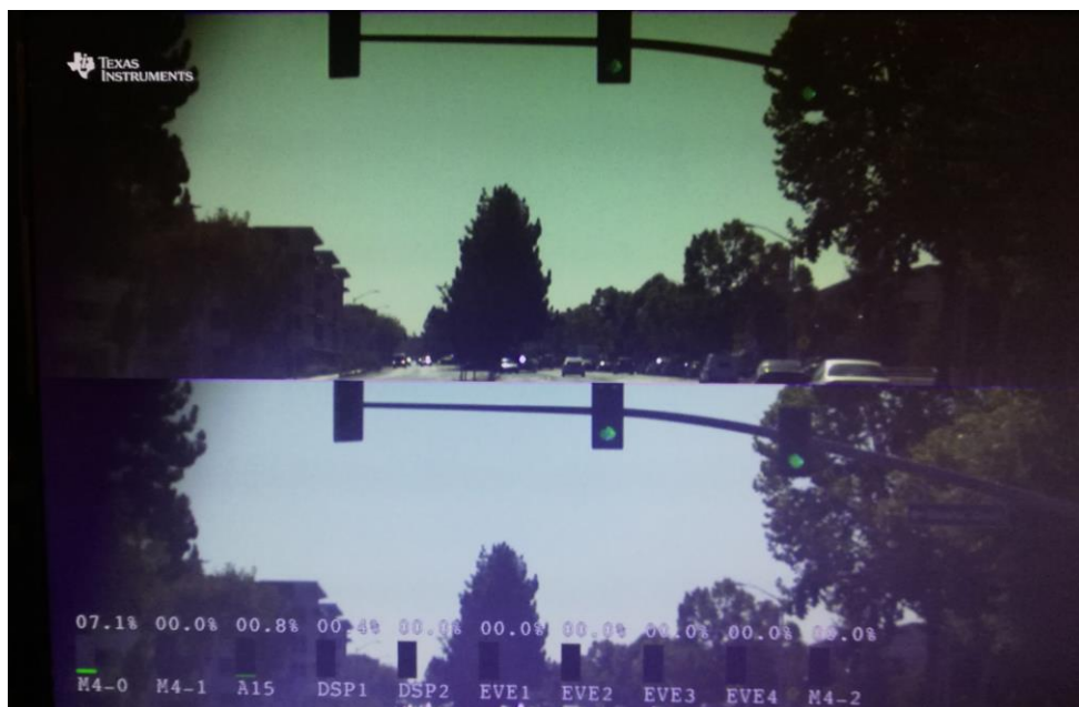
Slika 4.4. Prikaz detekcije svjetlosne prometne signalizacije u uvjetima niske osvjetljenosti.
