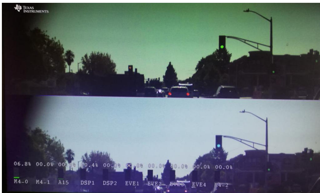
Slika 4.5. Prikaz detekcije stražnjih svjetala kao lažnih pozitiviva.
