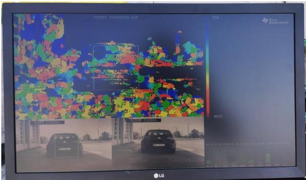
Sl. 4.8. Obojana disparitetna mapa rješenja zasnovanog na stereo paru slika, bez primjene FGS filtera te ispravljeni stereo par slika s detektiranim trećim testnim vozilom, na udaljenosti od šest metara.
