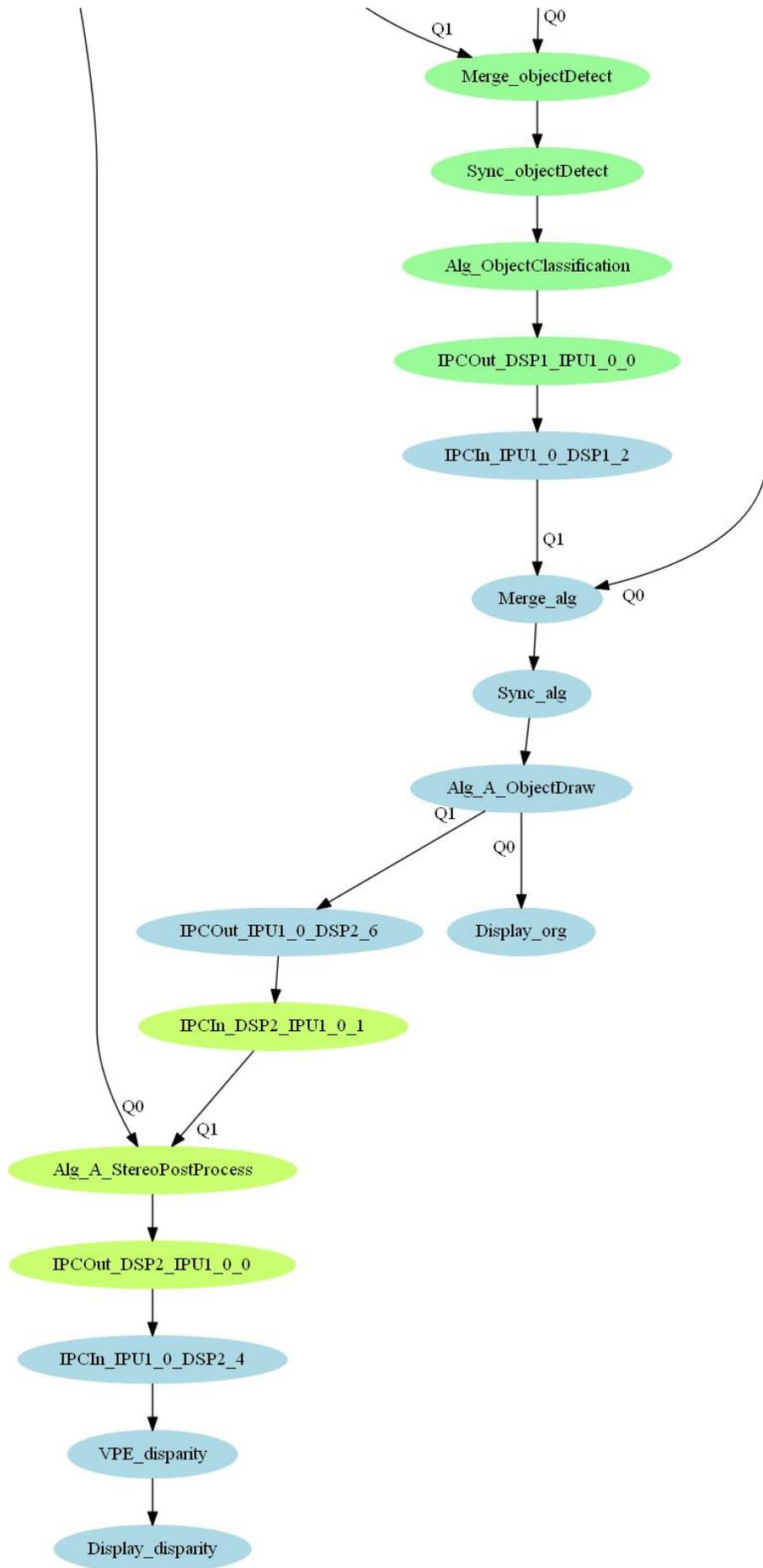
**P.3.6.** Dijagram toka slučaja upotrebe za određivanje udaljenosti detektiranog vozila zasnovanog na stereo paru slika, uz implementirani FGS filter bez navođenja.
