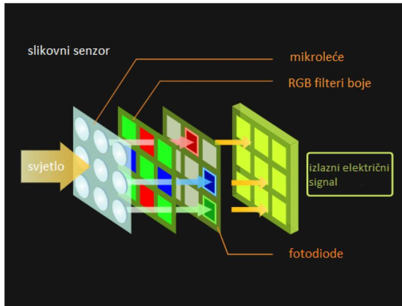
Sl. 2.5. Princip rada CMOS slikovnog senzora [6].
