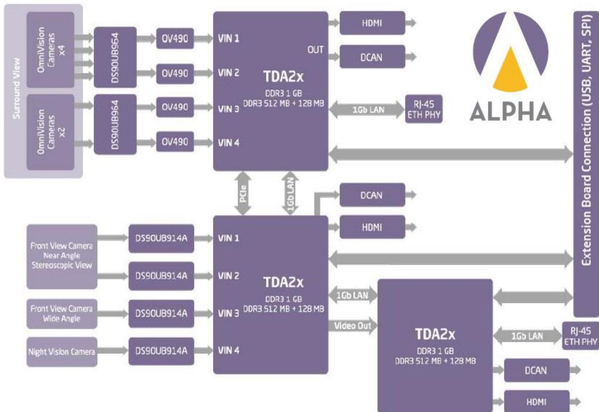
Sl. 3.2. Veze među pojedinim dijelovima ADAS ALPHA ploče [1].
