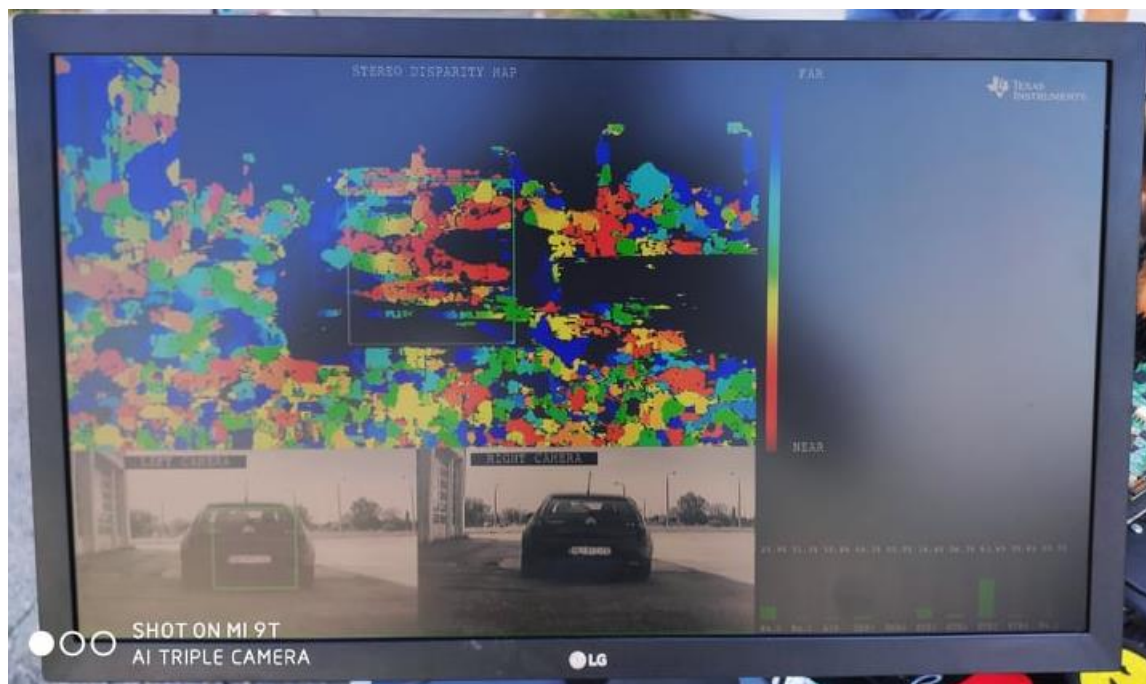
Sl. 4.6. Obojana disparitetna mapa rješenja zasnovanog na stereo paru slika, bez primjene FGS filtera te ispravljeni stereo par slika s detektiranim drugim testnim vozilom, na udaljenosti od šest metara.
