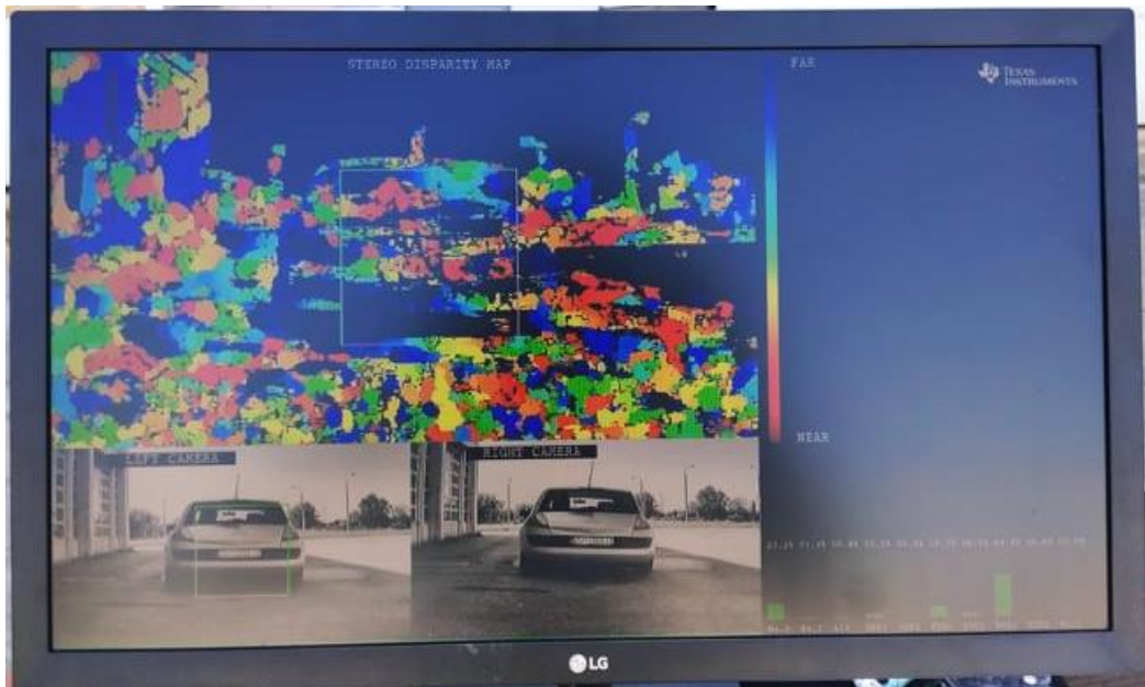
Sl. 4.4. Obojana disparitetna mapa rješenja zasnovanog na stereo paru slika, bez primjene FGS filtera te ispravljeni stereo par slika s detektiranim prvim testnim vozilom, na udaljenosti od šest metara.
