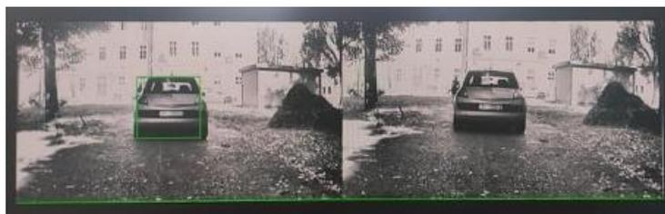
Sl. 3.7. Vozilo detektirano na ispravljenom paru video okvira.
