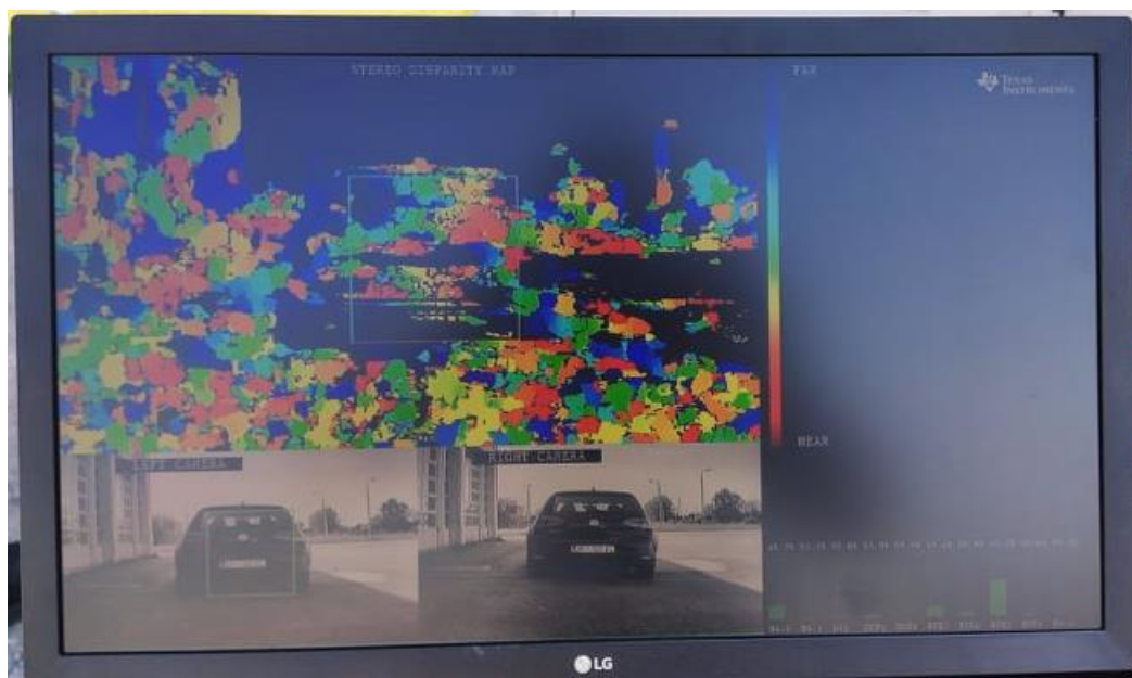
Sl. 4.8. Obojana disparitetna mapa rješenja zasnovanog na stereo paru slika, bez primjene FGS filtera te ispravljeni stereo par slika s detektiranim trećim testnim vozilom, na udaljenosti od šest metara.
