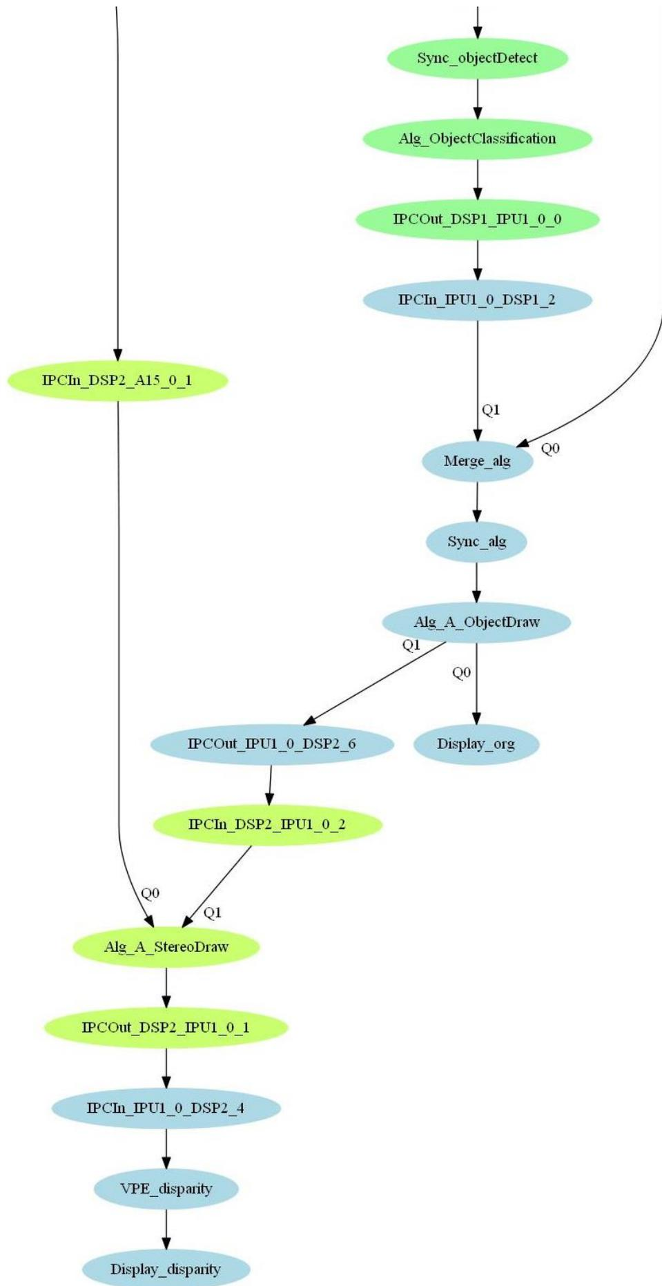
**P.3.7.** Dijagram toka slučaja upotrebe za određivanje udaljenosti detektiranog vozila zasnovanog na korištenju stereo para slika, uz implementirani FGS filter koji video okvir dobiven s lijeve kamere upotrebljava za navođenje.
