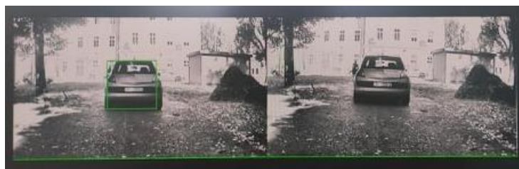
Sl. 3.7. Vozilo detektirano na ispravljenom paru video okvira.
