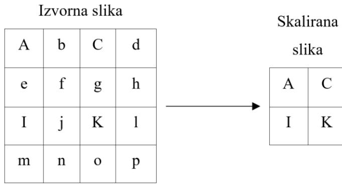
Sl. 2.9. Vizualni prikaz algoritma za skaliranje slike po pikselu.
