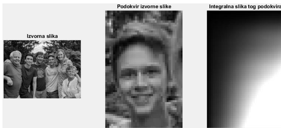
Sl. 3.6. Prikaz rezultata algoritma za računanje integralne slike podokvira, rađen u MATLAB -u.
