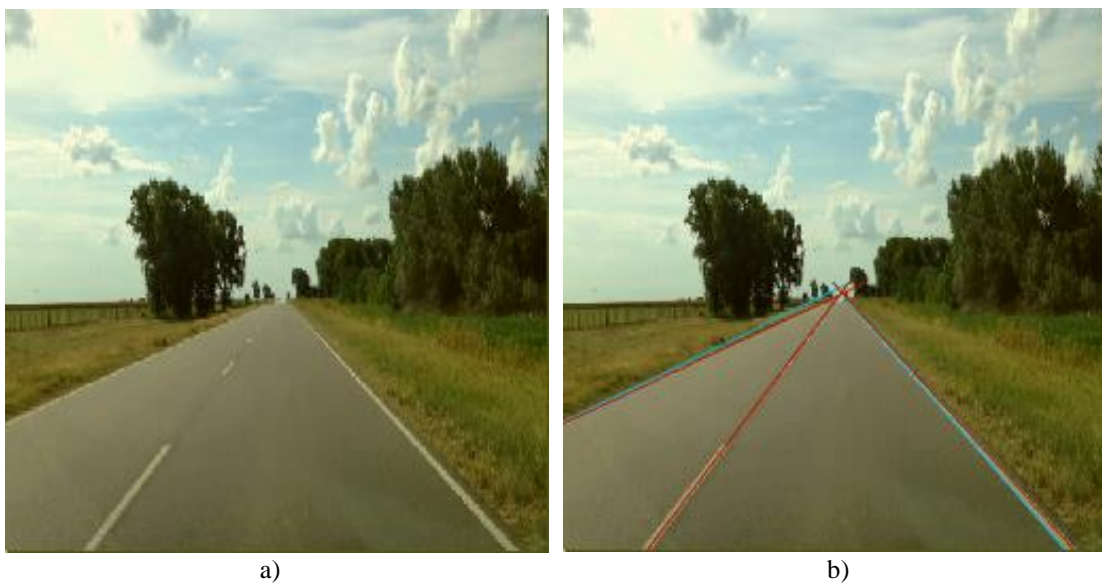
Sl. 4.2. a) ulazna slika 256x256 b) slika sa označenim pronađenim voznim linijama.
