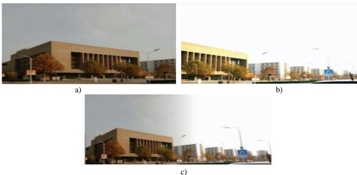
Sl. 2.3. Prikaz rezultata spajanja slika bez korekcije osvjetljenja slika za spajanje: (a) lijeva slika s vlastitim osvjetljenjem (b) desna slika s vlastitim osvjetljenjem (c) spojena lijeva i desna slika bez korekcije osvjetljenja [10]
