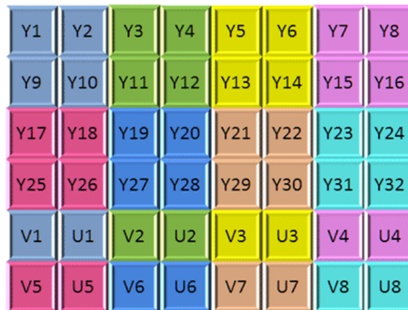
Sl. 3.4. Prikaz pod-uzorkovanja YUV420SP formata boje [21]
