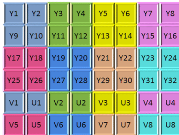
Sl. 3.4. Prikaz pod-uzorkovanja YUV420SP formata boje [21]
