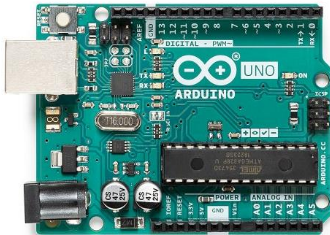
Sl. 3.1. Arduino Uno platforma [6]
