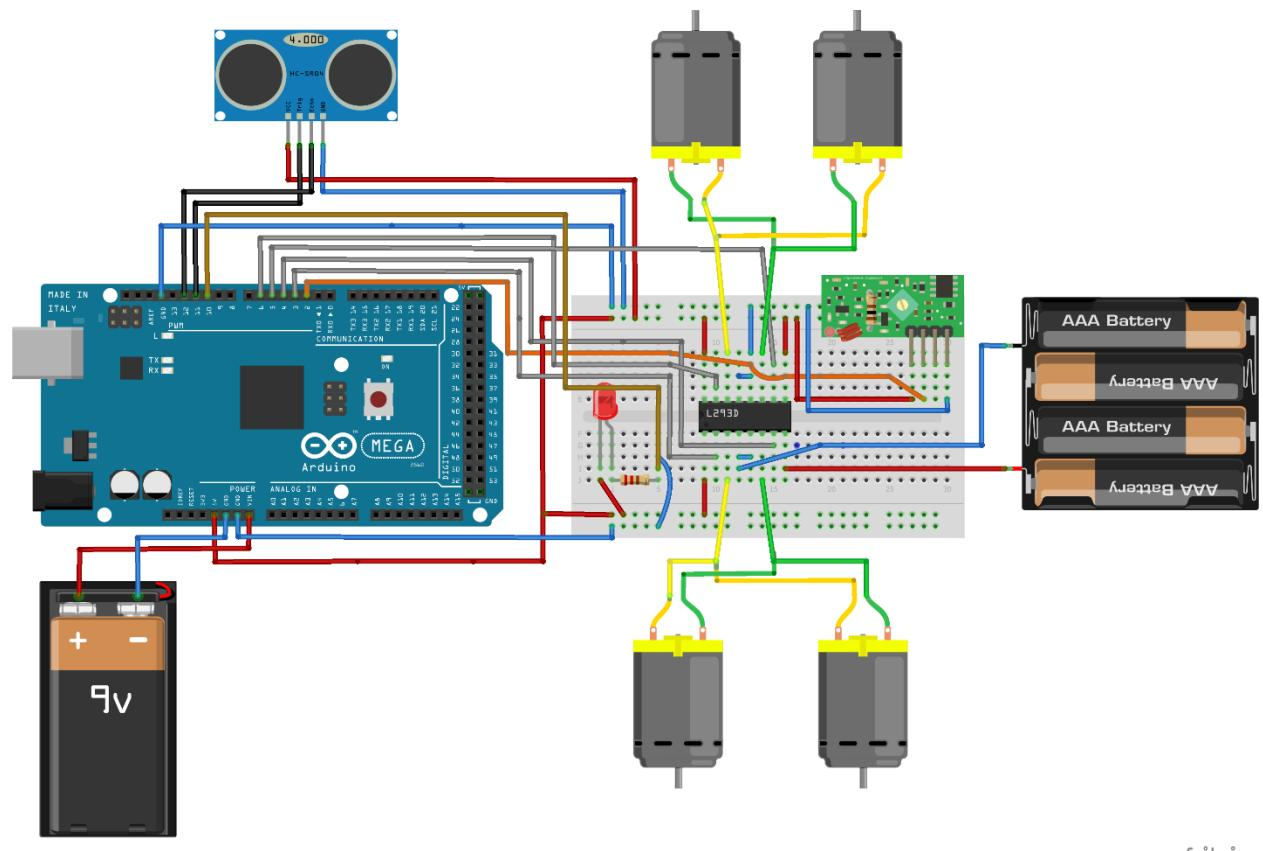
Sl. 4.1. Shema spajanja dijelova mobilnog robota
