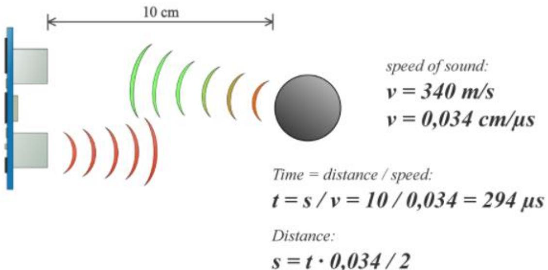
**Sl. 3.8.** Računanje udaljenosti pomoću HC-SR04 senzora [12]
