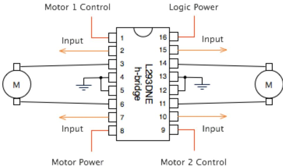
Sl. 3.7. Shema povezivanja L293d upravljača motora [11]
