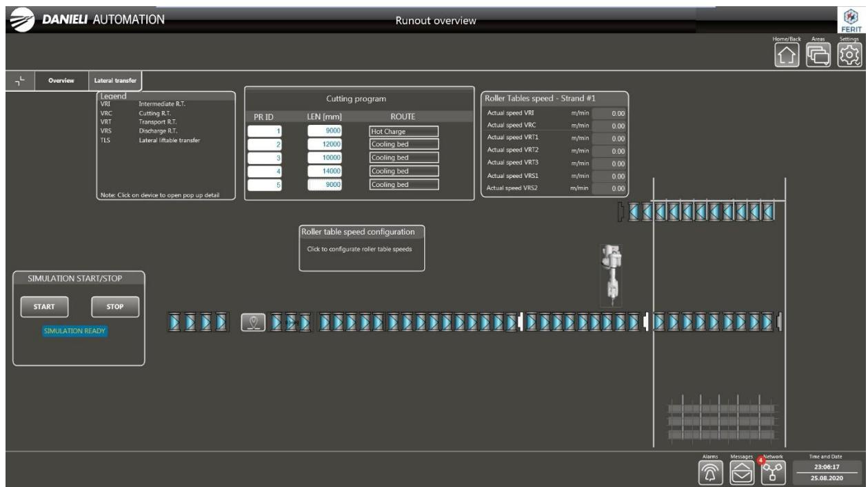
Slika 5.2. Prikaz cijelokupnog HMI-a
