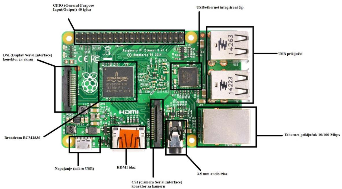
Slika 2.1. Raspberry Pi 2 Model B s prikazanim dijelovima.
