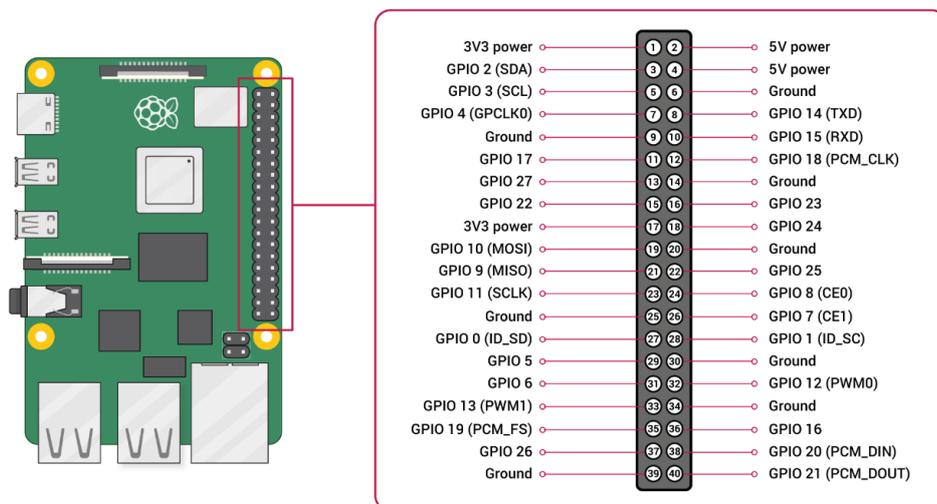
Slika 2.2. Shematski prikaz Raspberry Pi GPIO pinova.
