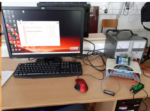
Slika 3.5. Uređaj podešen za rad na dva kanala i snimanje parametara na računalu
