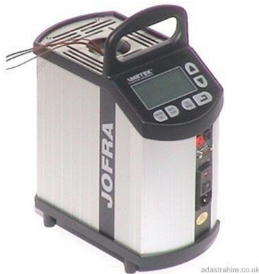
Slika 3.1. Uređaj za testiranje i kalibraciju kontaktnih termometara Jofra CTC.
